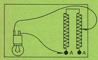
Lämpchen an Stromquelle und an den Spiralenwiderstand anpassen.
