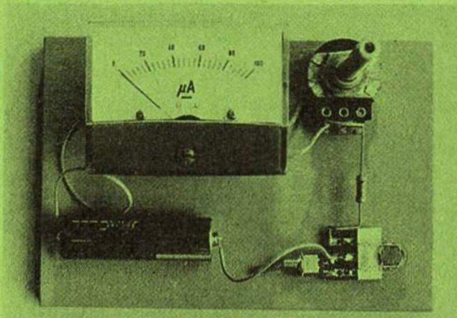
derstand, gestattet eine stufenlose Spannungsteilung. Potentiometer dienen auch der Lautstärkeregelung in Radios und Verstärkern.
