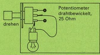
Der Schleifer am Mittelabgriff gleitet über den Draht, der als Spannungsteiler wirkt.
