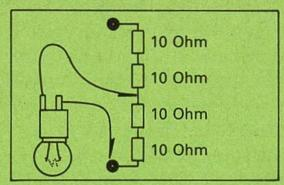
Zwischen den Widerständen kann man 3/4, 1/2, 1/4 der Stromquellenspannung abgreifen.
