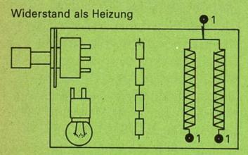
Widerstandsdraht (Konstantan 0,2 mm) 30 Windungen entsprechen 15 Ohm pro Spirale.
