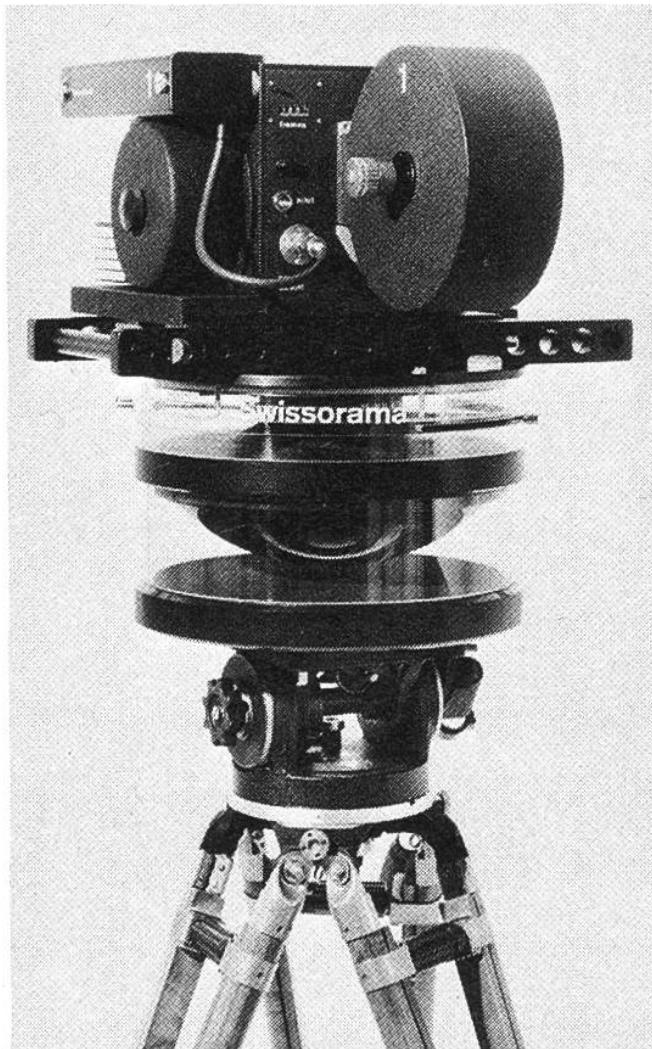
*Auch an der Aufnahmekamera sitzt das Fischaug-Objektiv senkrecht nach unten. Die Aufnahmerichtung indessen liegt quer zur optischen Achse. Die sich stark vorwölbende Frontlinse befindet sich geschützt hinter einem optisch fein bearbeiteten Zylindermantel aus Plexiglas, der gleichzeitig als Träger, respektive zur Abstützung von Kamera und Objektiv dient.*
