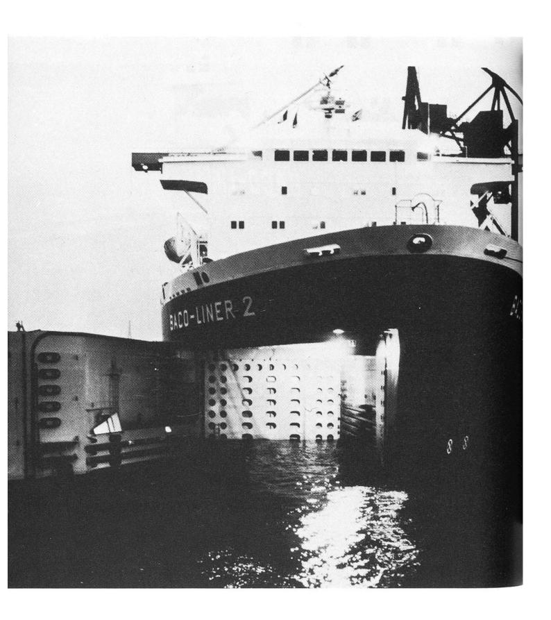
Wenn die Ladung eingeschwommen ist, werden die «Schleusentore» am Bug des Schiffes geschlossen. Das Wasser wird hinausgepumpt und wie in einem Trockendock können die Schiffe-im-Schiff die Reise über die Weltmeere antreten. Am Bestimmungsort wird wieder Wasser eingepumpt, die Schleusen öffnen sich und die Container-Schiffe oder der Binnengewässer-Tanker können ihre Weiterreise im Freien antreten.
