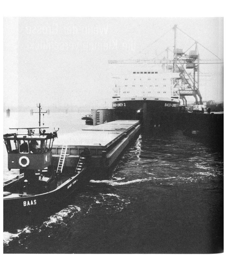
Am Pier vertäut, wird ein «Baco-Liner» beladen. Während mit den Kranen bis zu 500 grossräumige Container an Deck gehievt werden, ist auf dem Wasser ein Schlepper daran, eine Serie von 800 Tonnen Container-Schiffen in den Bauch des «gefrässigen Grossen» hineinzuschieben (in der Fachsprache: Container-Schiffe werden «eingeschwommen»).
