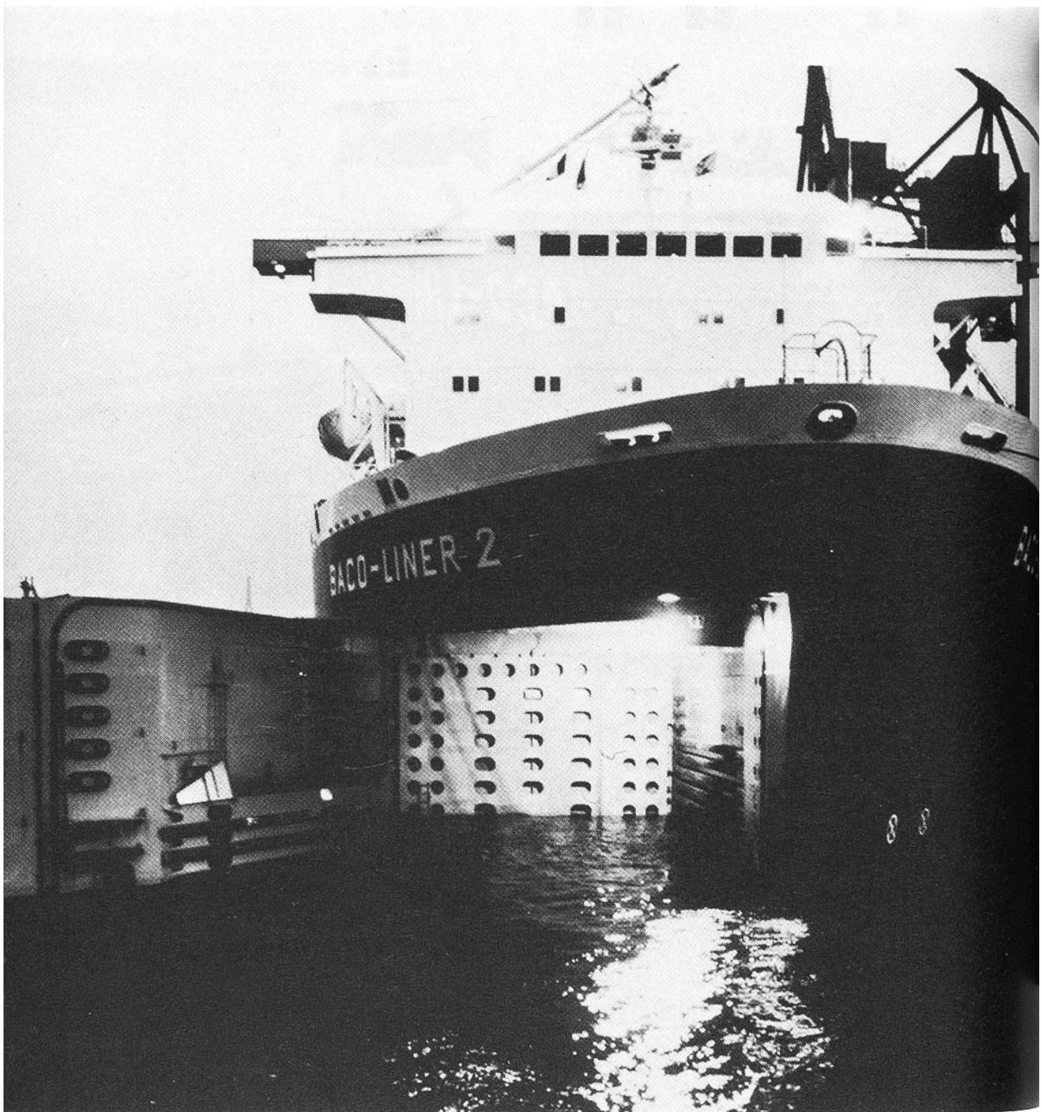
*Wenn die Ladung eingeschwommen ist, werden die «Schleusentore» am Bug des Schiffes geschlossen. Das Wasser wird hinausgepumpt und wie in einem Trockendock können die Schiffe-im-Schiff die Reise über die Weltmeere antreten. Am Bestimmungsort wird wieder Wasser eingepumpt, die Schleusen öffnen sich und die Container-Schiffe oder der Binnengewässer-Tanker können ihre Weiterreise im Freien antreten.*
