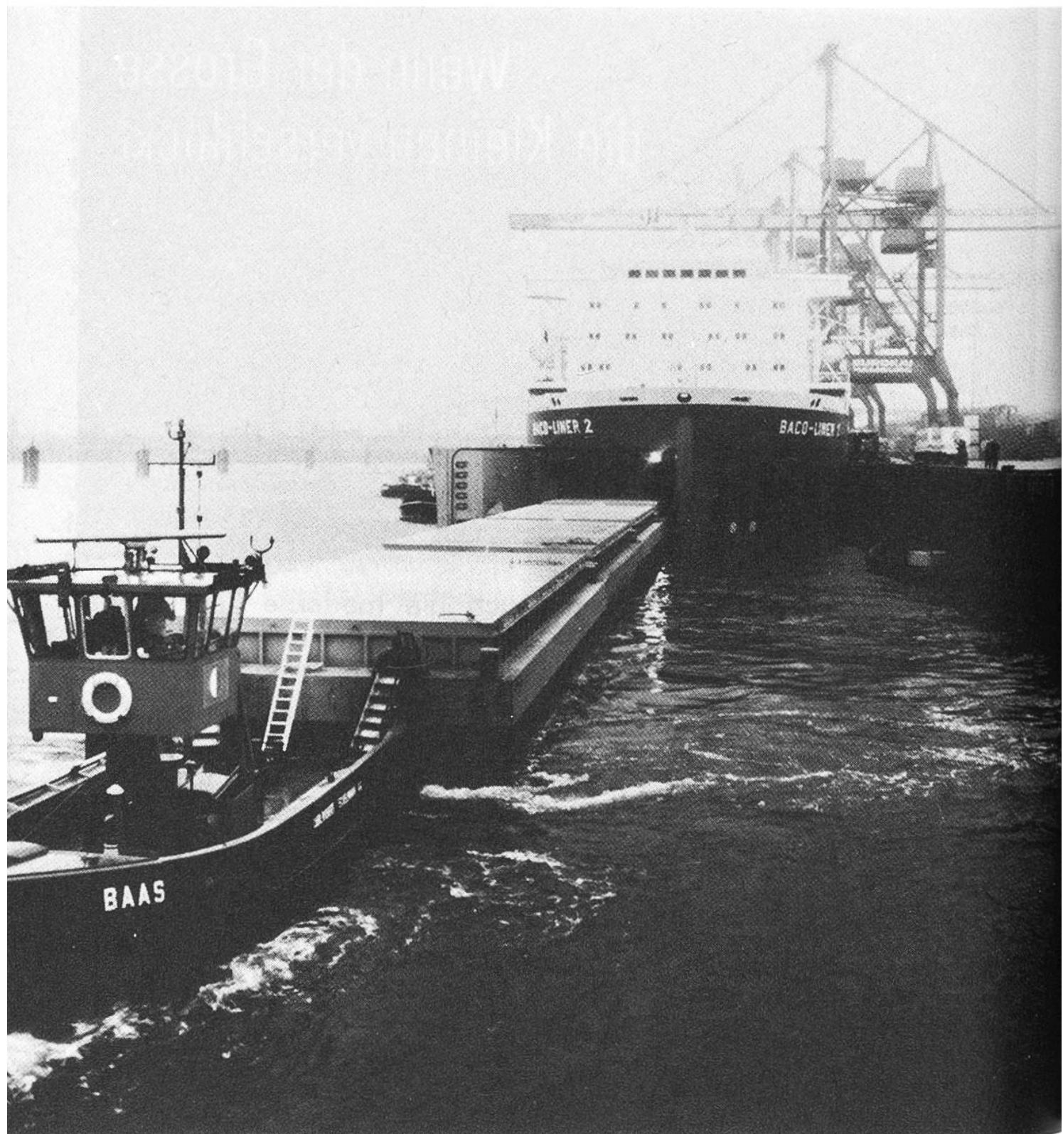
Am Pier vertäut, wird ein «Baco-Liner» beladen. Während mit den Kranen bis zu 500 grossräumige Container an Deck gehievt werden, ist auf dem Wasser ein Schlepper daran, eine Serie von 800 Tonnen Container-Schiffen in den Bauch des «gefrässigen Grossen» hineinzuschieben (in der Fachsprache: Container-Schiffe werden «eingeschwommen»).
