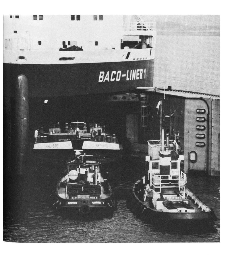
Hier wurde von zwei Schleppern ein Binnenwasser-Tanker von 995 Bruttoregistertonnen, einer Länge von 67 Metern, einer Breite von 8,2 Metern und einem Tiefgang von 2,7 Metern in den «Baco-Liner» eingeschwommen.
