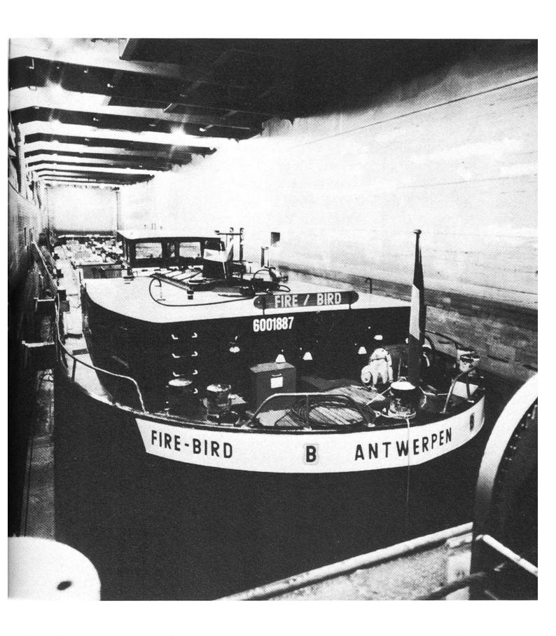
Im Bauch des «Baco-Liner» werden die eingeschwommenen Schiffe festgemacht und «verankert», so dass auch bei Sturm und hohem Wellengang nichts passieren kann.
