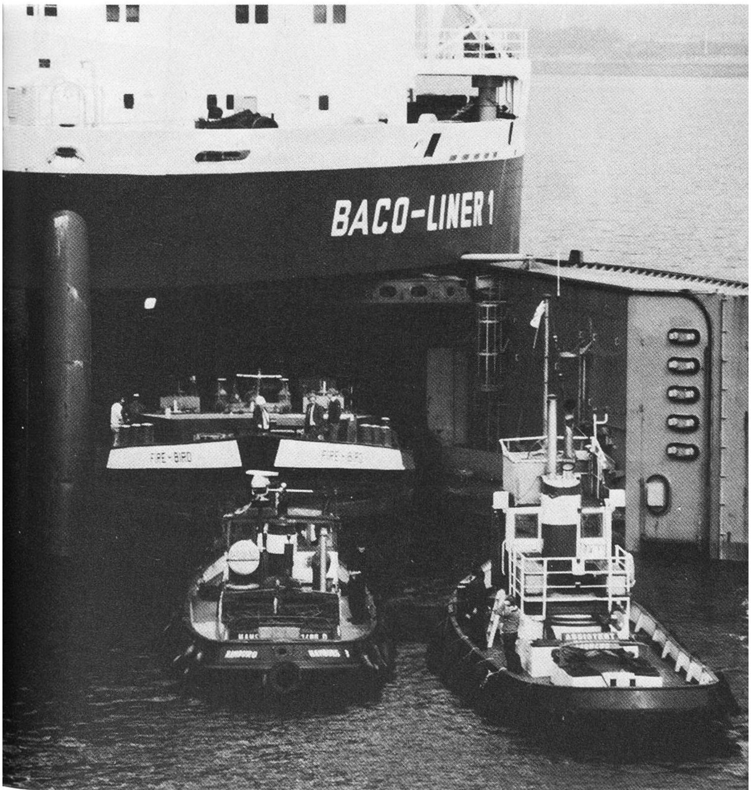
Hier wurde von zwei Schleppern ein Binnenwasser-Tanker von 995 Brutto-registertonnen, einer Länge von 67 Metern, einer Breite von 8,2 Metern und einem Tiefgang von 2,7 Metern in den «Baco-Liner» eingeschwommen.
