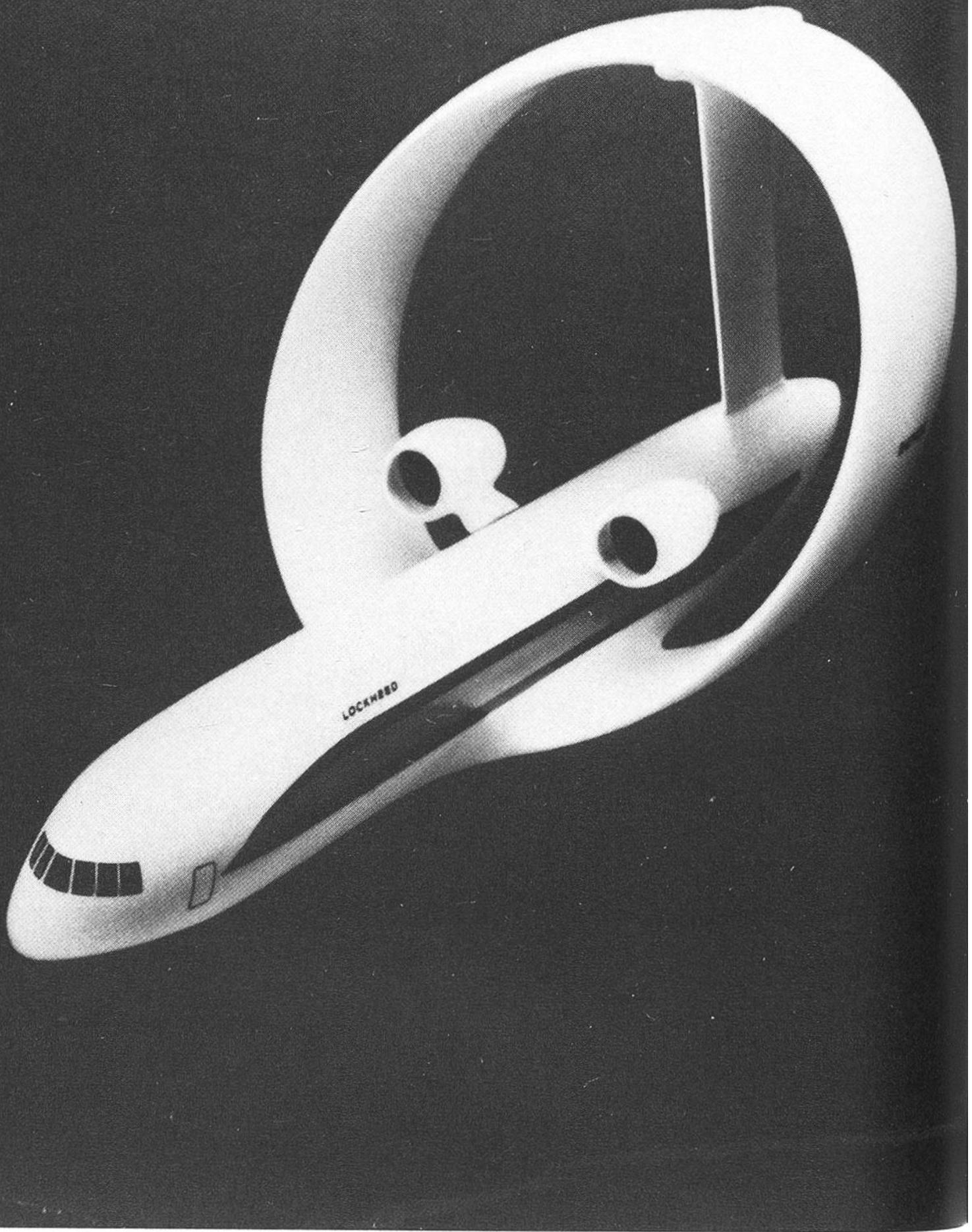
*Ein solcher Ringflügel – das ist bereits praktisch erprobt – kann den Wirkungsgrad und die Leistungen eines Flugzeuges erheblich verbessern. Bei gleicher Tragfähigkeit wiegt ein Ringflügel nur etwa die Hälfte eines konventionellen Flügels.*
