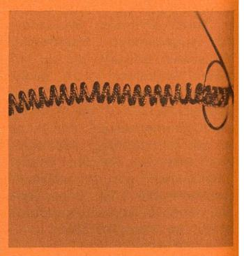
... um über die Konstruktion eines doppelt gewendelten Wolframdrahtes in einer Glühlampe staunen zu können.
