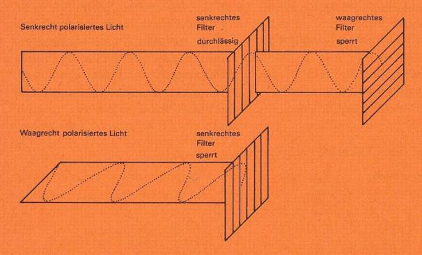
Über der vorderen Glasscheibe der Anzeigezelle liegt eine solche Polarisationsfolie, die nur die senkrecht schwingenden Wellen durchtreten lässt. Die Flüssigkristalle vermögen nun infolge ihrer gegenseitigen Lage dieses Licht um 90 Grad zu drehen, so dass es die Kammer in waagrechter Schwingrichtung verlassen kann, weil eine zweite, horizontal an-
