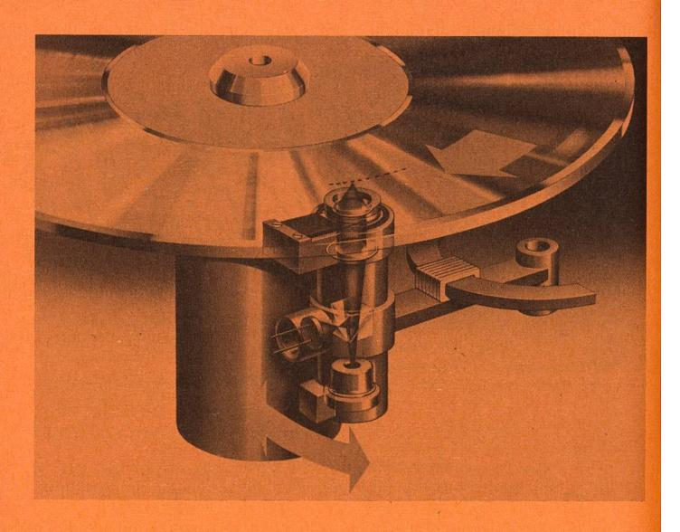
Oben: Der Laserstrahl trifft von unten auf die verspiegelte Schallplatte. Er wird präzise von innen nach aussen geführt. – Unten: Die Musik ist in Form mikroskopisch kleiner Grübchen (pits) auf der Kompaktplatte gespeichert.
