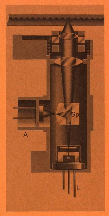
Die von der drehenden Platte zurückgespiegelten Lichtblitze werden auf das elektronische Auge umgelenkt. Dessen pulsierende Signale gelangen zur «Entschlüsselung» in den Rechner, der sie in Musik zurückverwandelt.
