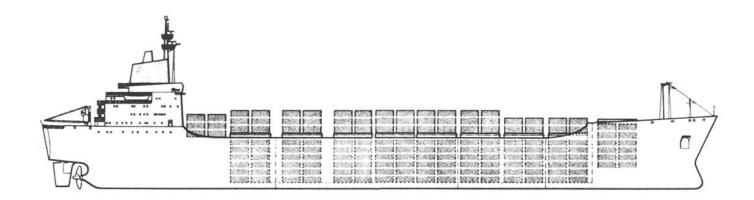
Der Längsschnitt durch ein Containerschiff zeigt auf den ersten Blick, um was es bei diesem modernen Schiffstyp geht: Das 227 m lange Schiff kann eine Riesenladung (1300 gleichgrosse Transportbehälter) schnell an Bord nehmen und im Zielhafen ebenso schnell an Land setzen. Dadurch werden Zeit, Arbeitskräfte und Geld gespart.
