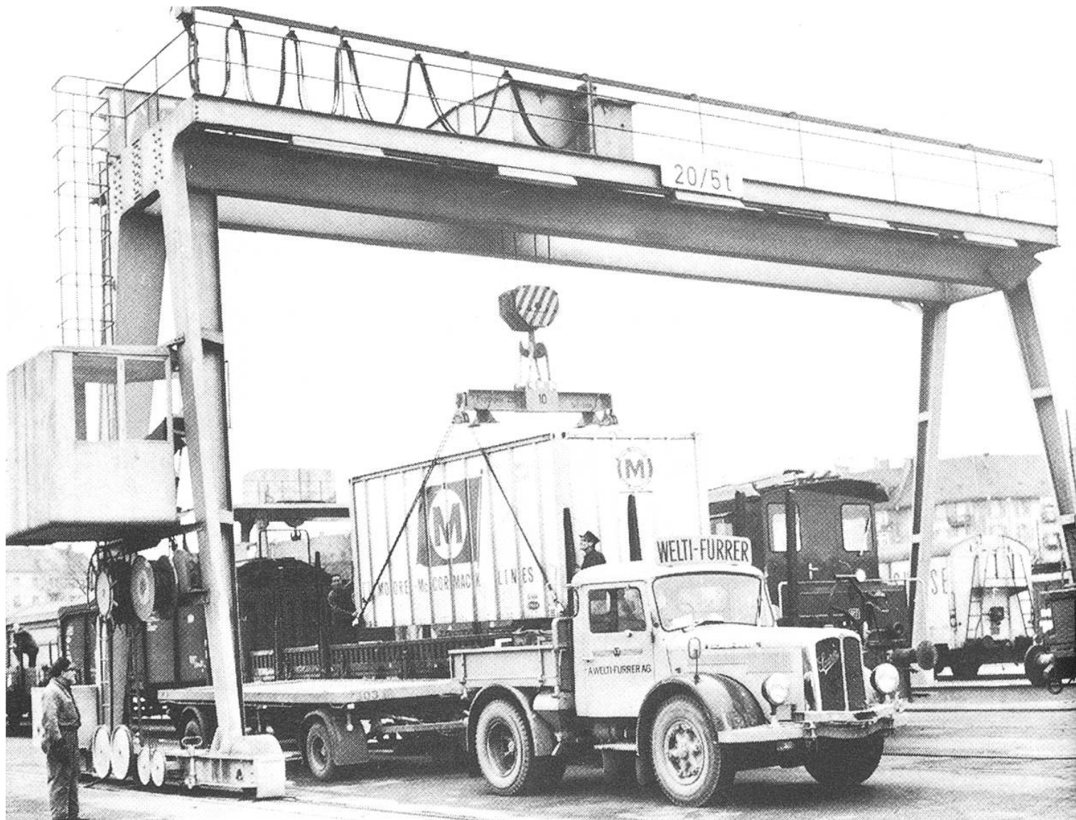
So ein Spezialtransporter mit 8 Rädern kann einen vollgeladenen Container spielend vom Boden heben, zum Schiff fahren und dort sanft unter dem Portalkran absetzen.
