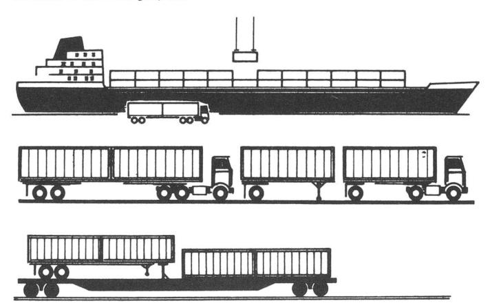
Vom Werk direkt ins Schiff. Die fertig gepackten Container (Grossbehälter mit genormten Massen: 6,05 m lang, 2,43 m breit und 2,59 m hoch) werden mit Sattelschleppern oder per Bahn an den Kai – möglichst direkt neben das Schiff – gefahren und mit Spezialkränen an Bord gehievt (bzw. umgekehrt).
