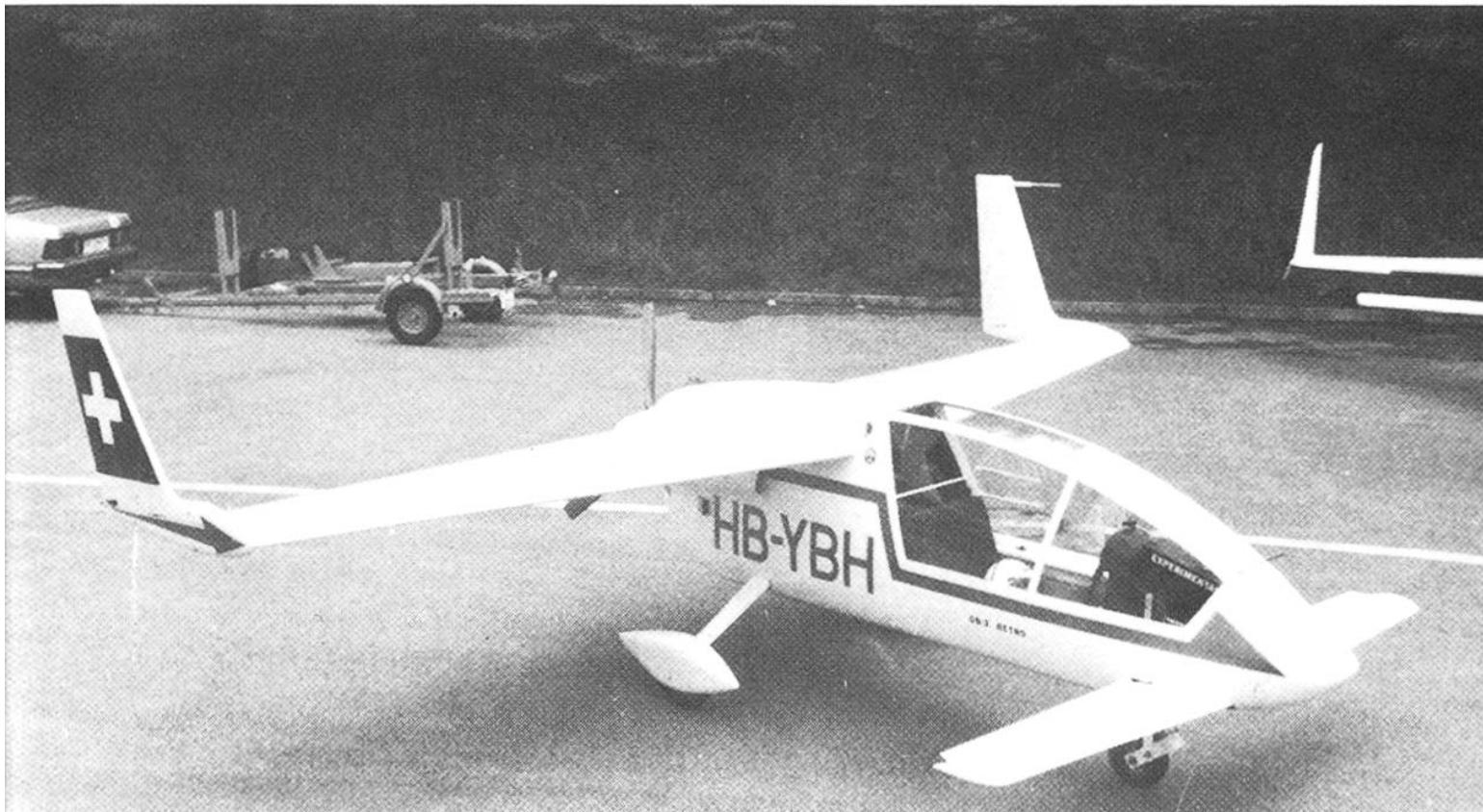
Gion Bezzolas zweiter Streich: «GB-2 Retro», gebaut in 2000 Stunden (geistige Vorarbeit nicht eingerechnet), angetrieben von einem alten VW-1600-Motor, Reisegeschwindigkeit 190 km/h, Reichweite 700 km. Das Auffallende an diesem Flugzeug ist, dass der Schwanz vorne liegt. Die grosszügige Verglasung des Cockpits hat ihm bereits den Übernamen «fliegendes Aquarium» eingetragen.
