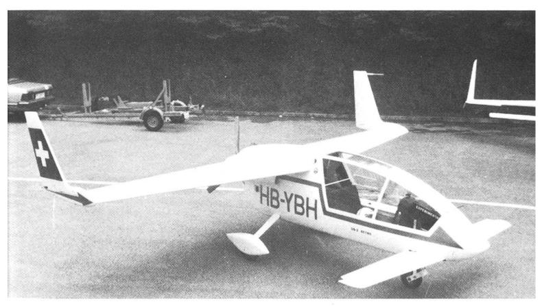
Gion Bezzolas zweiter Streich: «GB-2 Retro», gebaut in 2000 Stunden (geistige Vorarbeit nicht eingerechnet), angetrieben von einem alten VW-1600-Motor, Reisegeschwindigkeit 190 km/h, Reichweite 700 km. Das Auffallende an diesem Flugzeug ist, dass der Schwanz vorne liegt. Die grosszügige Verglasung des Cockpits hat ihm bereits den Übernamen «fliegendes Aquarium» eingetragen.
