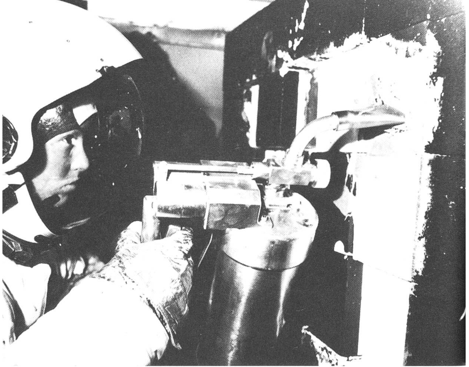
Arbeit im Weltraum kann auch heissen, dass eine Raumfähre in der Umlaufbahn repariert werden muss. Hier übt sich die Astronautin Anna L. Fisher im Beheben eines Schadens an den Hitzeschutzschindeln, die ein Space Shuttle bei seinem Wiedereintritt in die dichteren Luftschichten vor dem Verglühen bewahren müssen.
