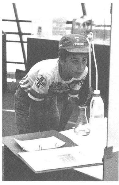
An diesem Gerät wird der Kalkgehalt des Wassers bestimmt (titriert). Je härter (kalkhaltiger) das Wasser, desto mehr Waschpulver wird benötigt. Ein Zuviel schadet unseren Gewässern!
