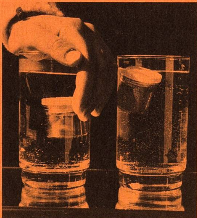
Das Tauchdöschen ist mit feinem Sand ausgewogen; es ist ganz wenig leichter als Wasser. Bei Druck auf die Glasöffnung taucht es, ohne dass man es berühren muss.
