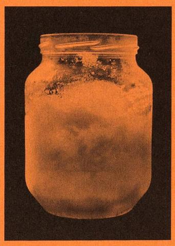
Am Gefäss mit der Kältemischung setzt sich Rauhreif an, weil der Wasserdampf in der Luft gefriert.
