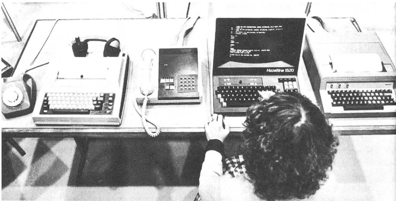
*Eine Auswahl von Geräten, mit denen man via Telefon über beliebige Entfernungen mit einem Computer in Verbindung treten kann. Ganz links eine tragbare Maschine, an der der Telefonhörer ganz einfach festgeschnallt werden kann. Ähnliche Geräte benützen Presseleute, um ihre Berichte an die Redaktion zu senden.*
