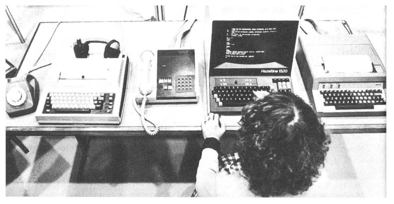
Eine Auswahl von Geräten, mit denen man via Telefon über beliebige Entfernungen mit einem Computer in Verbindung treten kann. Ganz links eine tragbare Maschine, an der der Telefonhörer ganz einfach festgeschnallt werden kann. Ähnliche Geräte benützen Presseleute, um ihre Berichte an die Redaktion zu senden.
