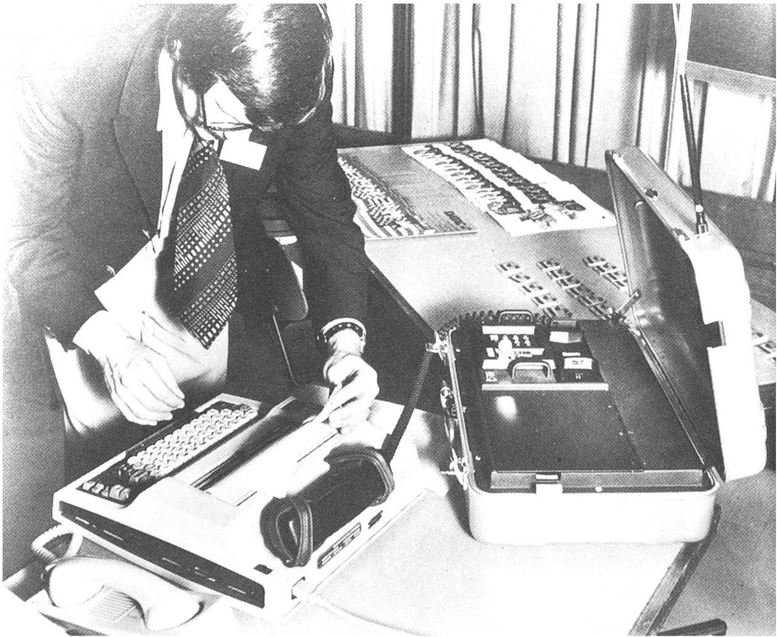
*Gipfel der Mobilität: Über das tragbare Telefon (rechts im Bild ein Natel-Koffer mit Antenne) und das tragbare Terminal (links) hat der Ingenieur von Luzern aus bei einem Computer in den USA eine Auskunft eingeholt, die er jetzt abreisst. Dauer der ganzen Angelegenheit: 3 Minuten.*
