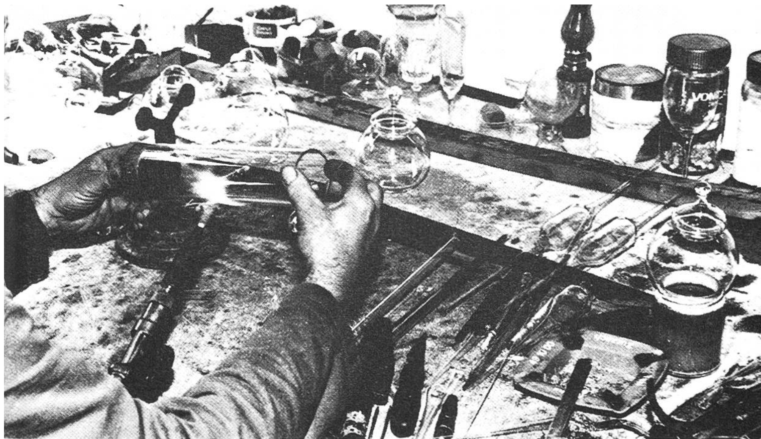
Aus diesem Zylinder entstehen gleich zwei Mostgläser. Der erweichte Mittelteil wird zum Boden der beiden Gläser verformt.
