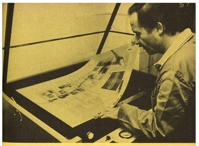
Der Buchdrucker-Offsetdrucker passt seine Montage selber genau auf die Offsetdruckplatte ein, bevor er diese im Kopiergerät belichtet.
