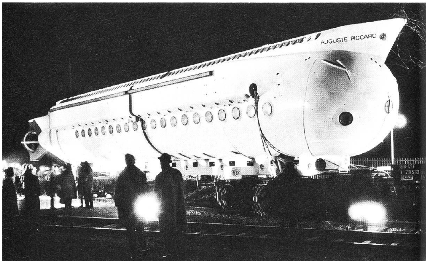
Die «Auguste Piccard» war die Publikumsattraktion der schweizerischen Landesausstellung 1964 in Lausanne. Das U-Boot führte die Besucher in die – leider sehr schmutzigen – Tiefen des Genfersees. Deutlich erkennt man über der Fensterreihe den Wulst der seitlichen Tauchtanks. Die Tiefenruder sind hier noch nicht montiert. In ihren Öffnungen greifen die Halteseile an.
