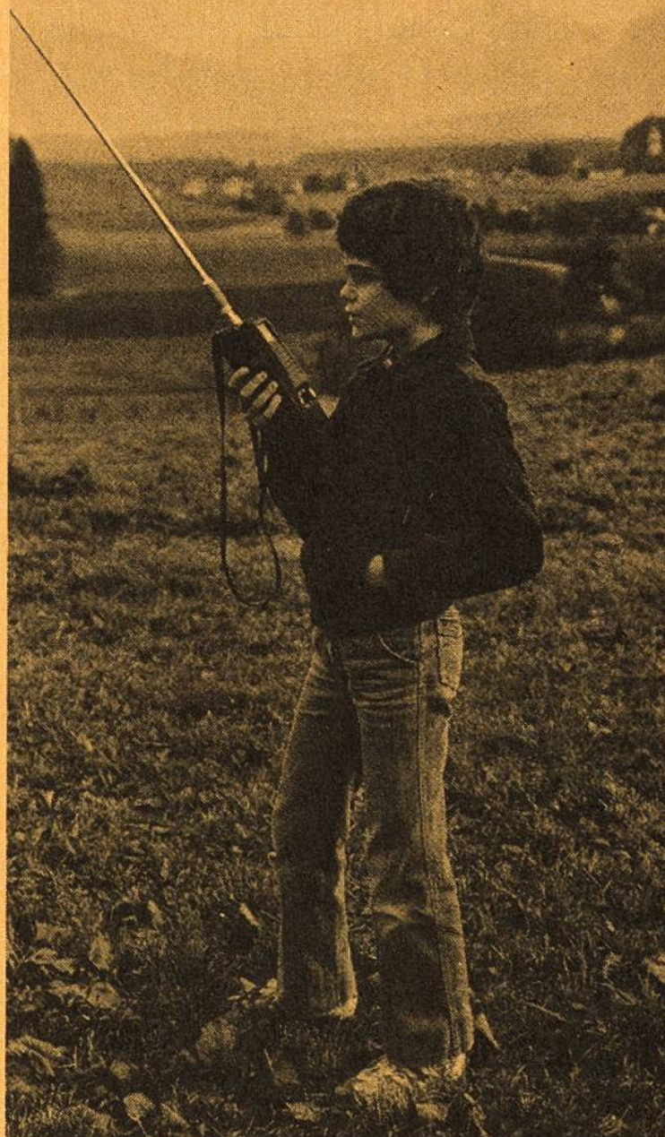
Erhöhte Standorte mit freier Sicht übers Land sind für die Ausbreitung der Funkwellen besonders günstig.
