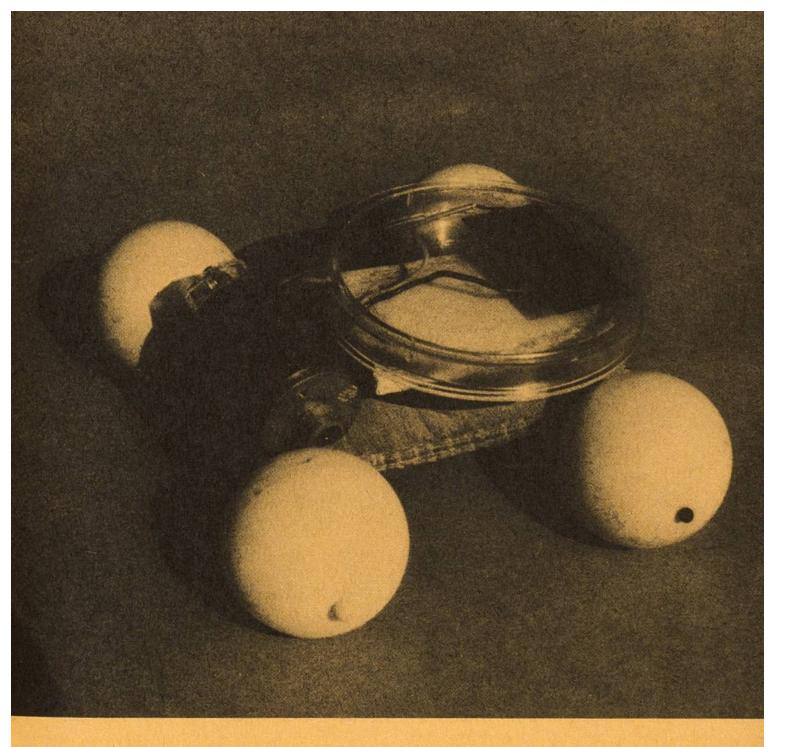
über das Zahnrad, der andere bindet es mit einem Faden fest. Mit dem Lötkolben löten wir zwei Drähte an die Zelle und verbinden sie mit dem Motor (siehe Zeichnung). Die Zelle kommt in das Plastikschächteli, welches wir 1 cm erhöht auf das Brettchen leimen. Den Motor zuerst mit Klebband, nachher mit Leim so auf das Brett kleben, dass das Gümmeli am Zahnrad einen Ping-
