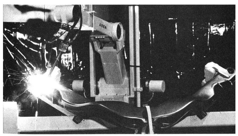
Dieser Industrie-Roboter setzt selbsttätig Schweissnähte am hinteren Achsträger eines Personenwagens. Er arbeitet nicht nur überaus fleissig, sondern auch höchst exakt und entlastet den Menschen von ermüdender Arbeit im Einflussbereich von Hitze, Strahlung und Schweissgasen.
