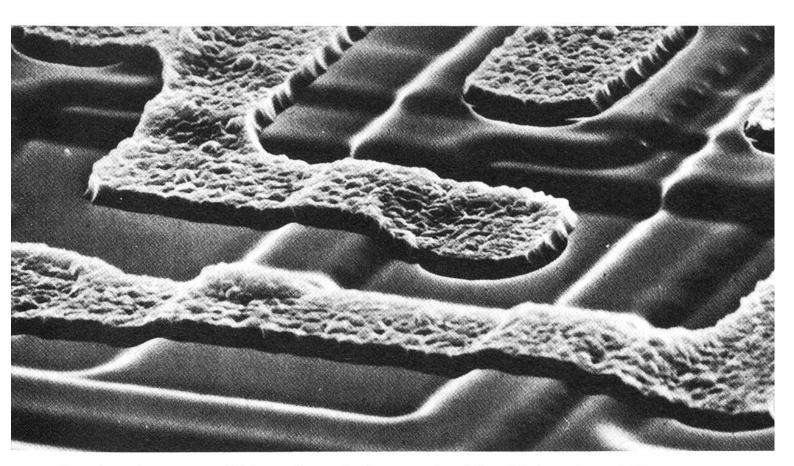
Das ist ein extrem kleiner Ausschnitt aus der Oberfläche eines Mikroprozessors – millionenfach vergrössert durch das Rasterelektronenmikroskop. Was dieses Bild zeigt, ist in Wirklichkeit nur 15 Millionstel Quadratmillimeter gross und Teil der Integrierten Schaltung einer elektronischen Digitaluhr.
