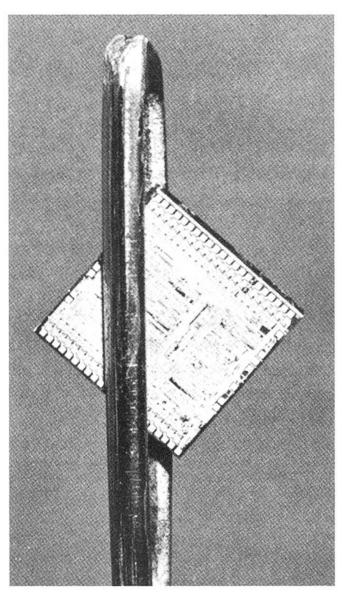
Das ist ein einzelner Mikroprozessor – so klein, dass er bequem durch ein Nadelöhr geht. Haarfeine Muster auf seiner Siliziumfläche erfüllen mit ihren verschiedenartigen Strukturen dieselben Aufgaben wie viele tausend herkömmliche elektronische Bauelemente.
