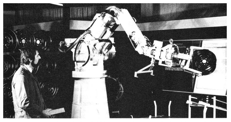
So sieht ein moderner Industrie-Roboter aus, der gestapelte Autofelgen auf ein Förderband legt. Das «Gehirnchen», das die komplizierten Funktionen des gigantischen stählernen Arms steuert, ist ein wenige Quadratmillimeter grosses Plättchen aus Silizium – genannt Mikroprozessor.
