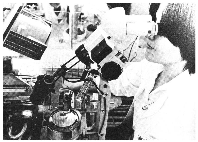
Mikroprozessoren müssen mit elektrischen Anschlüssen versehen und in eine schützende Umhüllung gebracht werden. Auch dies besorgen Automaten, doch der Mensch muss deren Funktion überwachen. Das kann er in diesem Falle freilich nur mit Hilfe stark vergrössernder optischer Instrumente.
