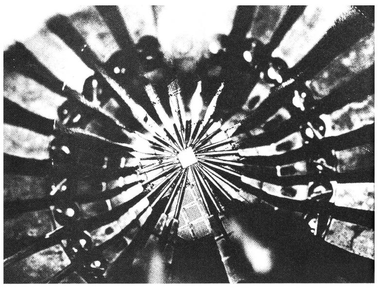
Vor dem Einbau sind Mikroprozessoren auf korrekte Funktion hin zu überprüfen. Dies wird seinerseits von Robotern besorgt, von Prüfautomaten für Integrierte Schaltkreise. Um elektrische Verbindung mit den noch unmontierten Siliziumplättchen herzustellen, bringen solche Prüfroboter haarfeine Sonden auf die entsprechenden Anschlussstellen – hier im Bild sind es deren 19. In Sekundenschnelle wird dann eine Vielzahl von Funktionstests ausgeführt.
