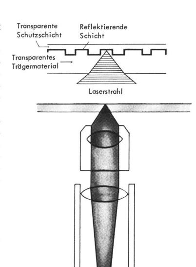
Schema des optischen Abtastsystems mit Laserquelle (unten) und Fotodiode (rechts).
