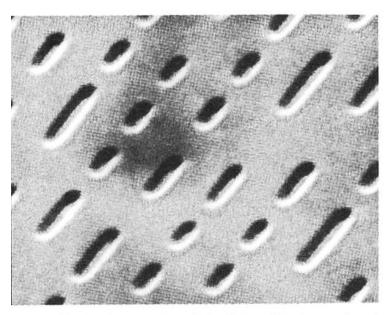
Aufnahme der CD-Oberfläche mit einem Rasterelektronenmikroskop 5000fach vergrössert.
