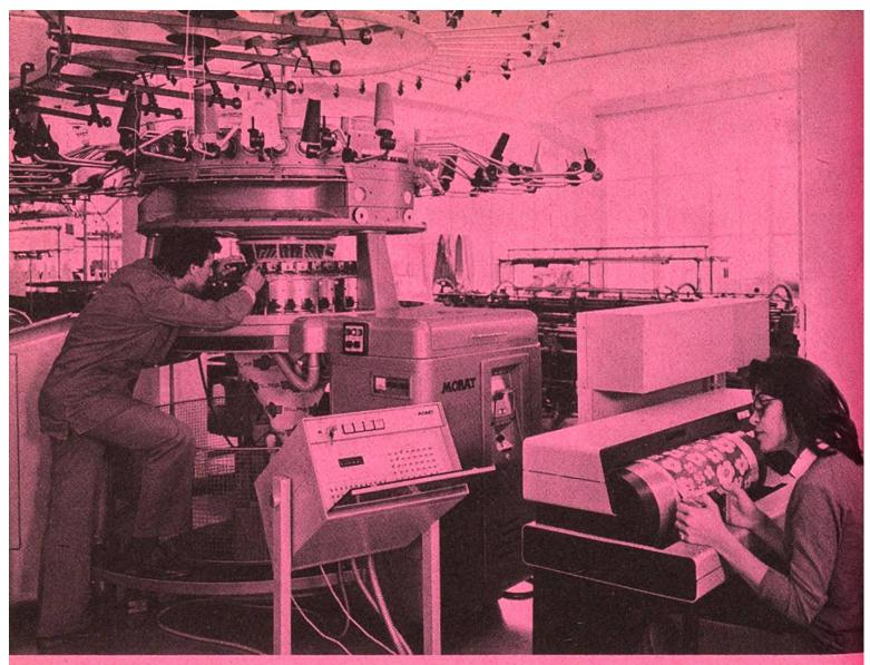
Eine Rundstrickmaschine mit elektronischer Steuerung wird eingerichtet.
