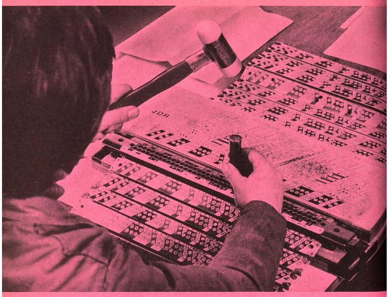
Schlagen der Lochkarten – ein möglicher Datenträger für die Steuerung der Maschine.
