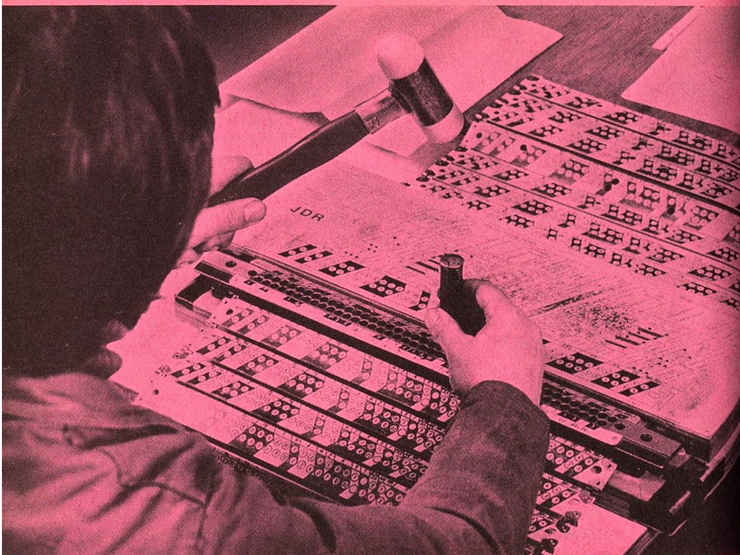
Schlagen der Lochkarten – ein möglicher Datenträger für die Steuerung der Maschine.
