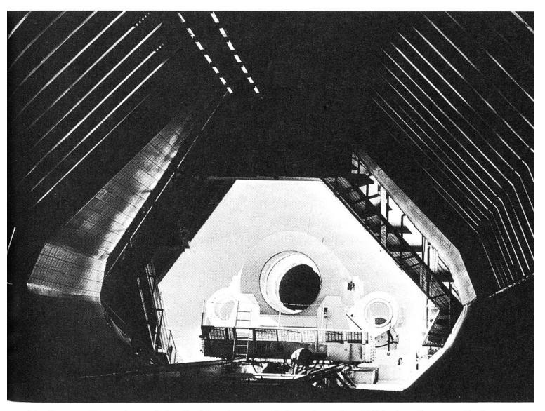
Und so präsentiert sich die Tragkonstruktion des das Bild der Sonne einfangenden Spiegels aus dem schrägliegenden Beobachtungstunnel gesehen. Das Ganze läuft auf Schienen und kann ein- und ausgefahren werden.
