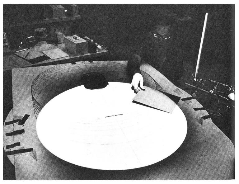
Dies ist das im Beobachtungsraum erzeugte Abbild der Sonne. Es weist einen Durchmesser von 86 Zentimetern auf und ist gross genug, dass die Wissenschafter unter anderem die feinkörnige Struktur der Sonnenoberfläche, die sogenannte Granulation, im Detail untersuchen können.
