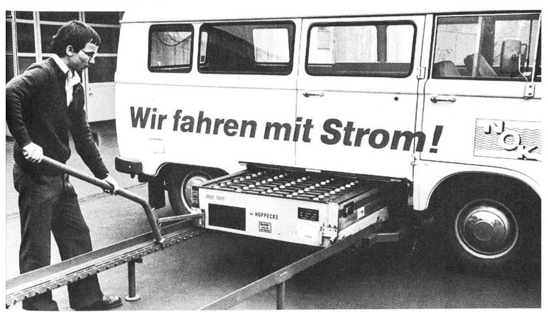
Kommt der elektrische Strassenverkehr? An der Weiterentwicklung des Elektromobils wird eifrig gearbeitet, und mit Versuchsfahrzeugen sammelt man Erfahrungen. Der Pferdefuss liegt bei den Batterien: Die heute verwendeten Bleiakkumulatoren weisen Nachteile hinsichtlich Gewicht, Fassungsvermögen und Lebensdauer auf.
