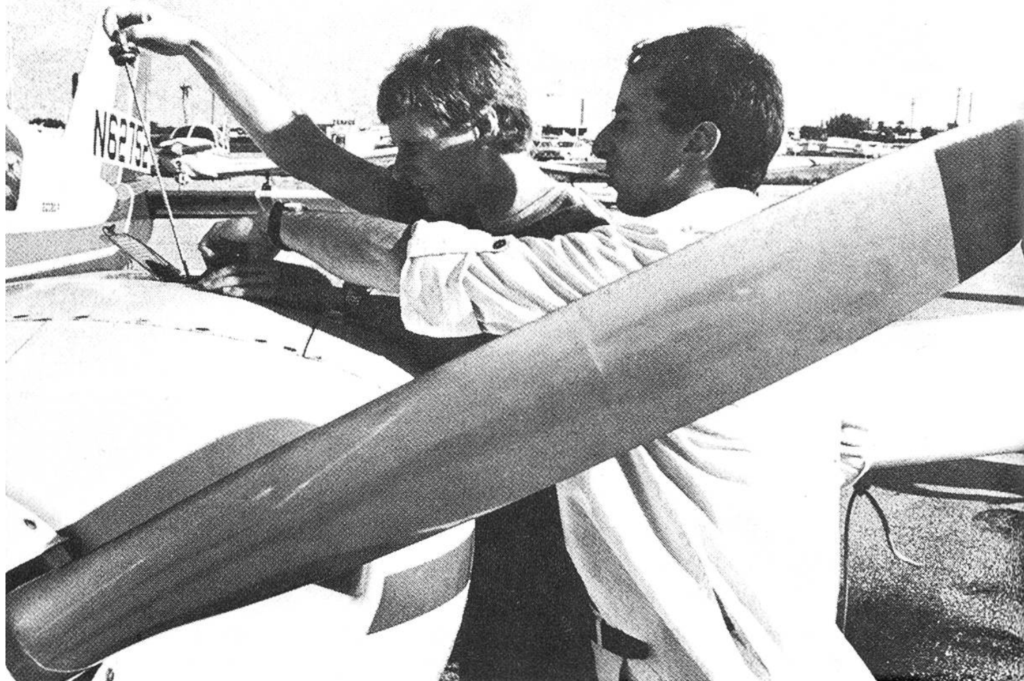
Eine genaue Kontrolle des Flugzeuges – hier eine Piper Aztek F – gehört mit zur Flugvorbereitung. Hier wird der Ölstand geprüft.
