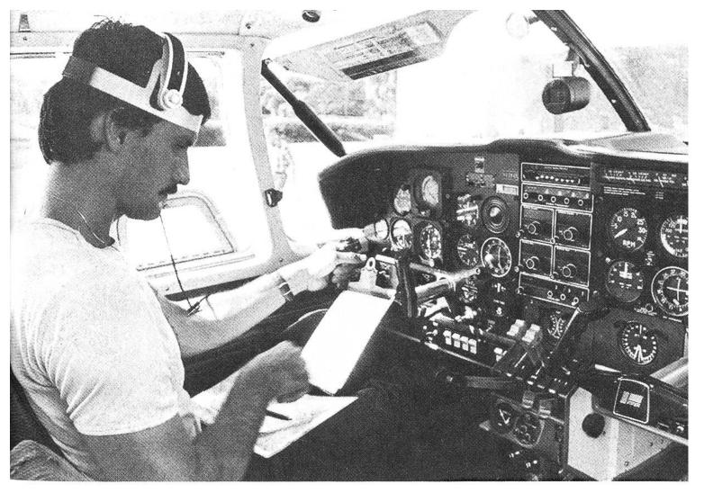
Cockpit-Check vor dem Start. Der Pilot trägt bereits die Halterung für die Blindflugscheuklappe auf dem Kopf, die später montiert wird und den Blick dann nur noch auf die Instrumente freilässt.
