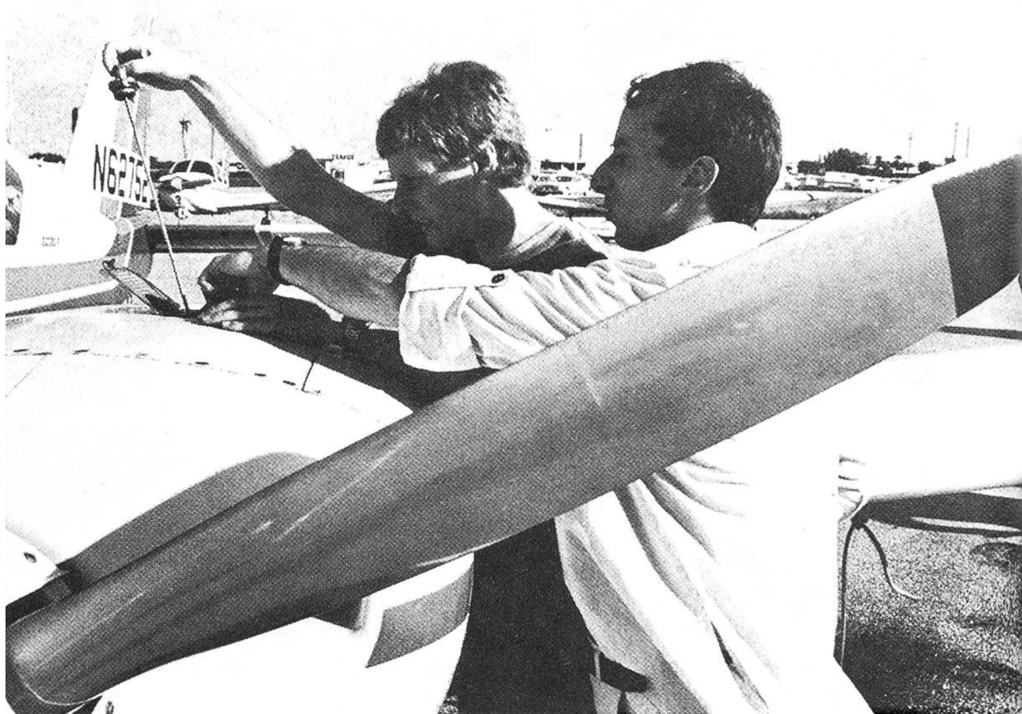
Eine genaue Kontrolle des Flugzeuges – hier eine Piper Aztek F – gehört mit zur Flugvorbereitung. Hier wird der Ölstand geprüft.
