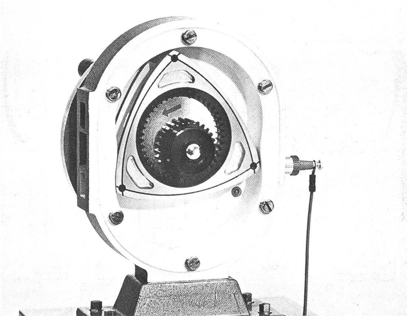
müssen, sind die Ventile mit den zugehörigen komplizierten Gestängen und Hebeln, die Pleuelstangen, die Kurbel- und Nockenwelle. Der Wankel weist, und dies erscheint uns höchst bemerkenswert, nur noch zwei bewegte Teile auf – und beide vollführen eine Drehbewegung.
