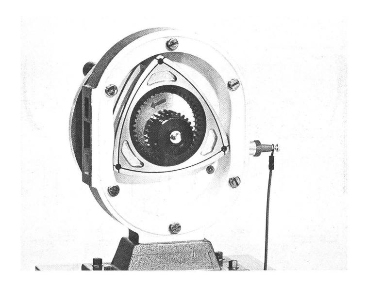
missen, sind die Ventile mit den zugehörigen komplizierten Gestängen und Hebeln, die Pleuelstangen, die Kurbel- und Nockenwelle. Der Wankel weist, und dies erscheint uns höchst bemerkenswert, nur noch zwei bewegte Teile auf – und beide vollführen eine Drehbewegung.
