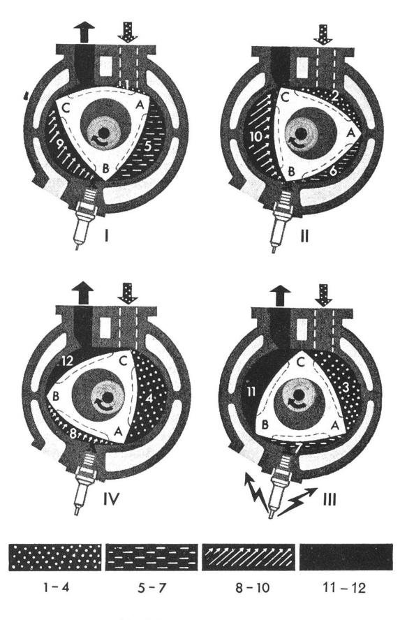
Ansaugen des Verdichten Arbeitshub Ausschieben der Gasluftgemisches Zünden Abgase
