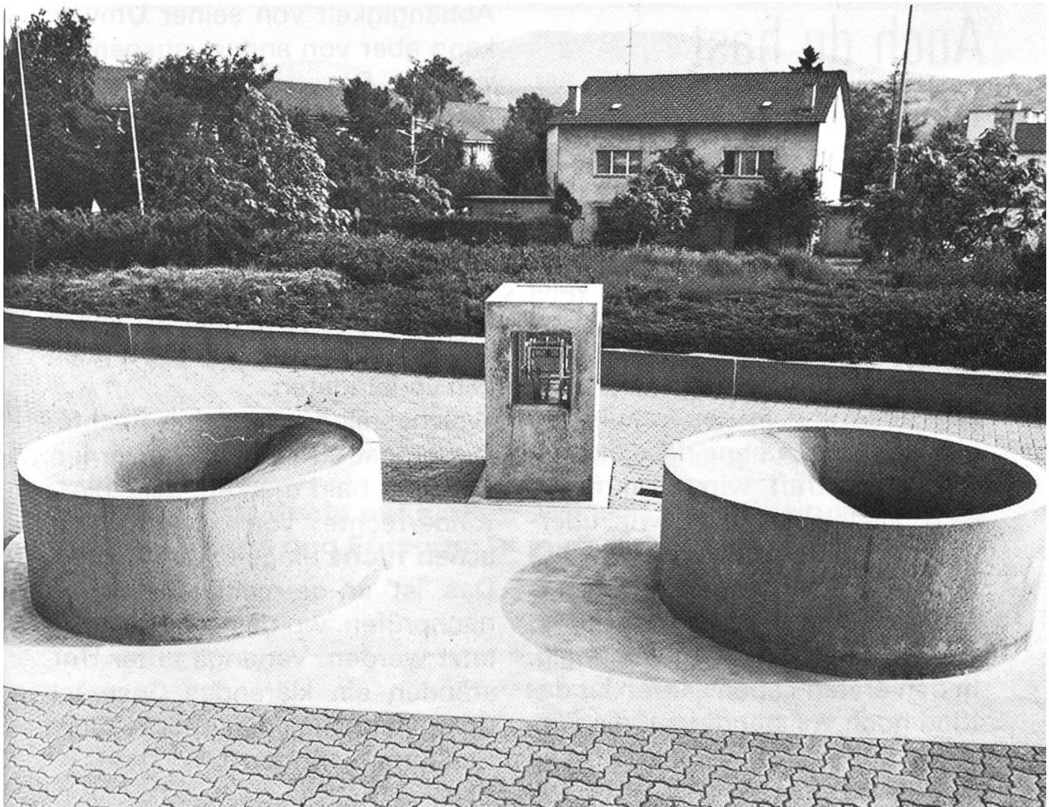
Steuerung (mittels einer besonderen «Kurvenscheibe» für jeden Mondmonat der nächsten 50 Jahre) eingerichtet werden. Sie befindet sich in einem Steuerungsgehäuse und reguliert den Wasserstand in einem als «Trommelregulator» ausgebildeten kommunizierenden Gefäß. – Der Mondbrunnen bildet also mit mechanischen Mitteln einen kosmischen Vorgang ab.
