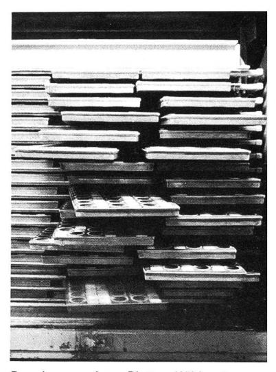
Das Innere eines Platten-Kühlgerätes. Das Kühlmittel fliesst bei einer Temperatur von -40°C durch die hohlen Platten, welche auf die zu kühlende Ware gepresst werden. So wird dem Gefriergut sehr schnell Wärme entzogen. Die Technik hat heute eine ganze Reihe von Verfahren zur Verfügung, um die gewünschte rasche Abkühlung zu erreichen.
