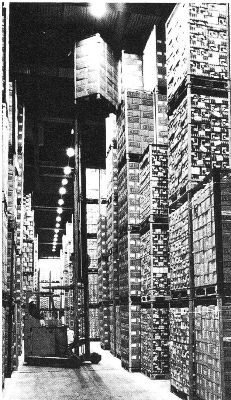
Ein modernes Tiefkühlagerhaus von innen. Je grösser das Haus, um so günstiger das Verhältnis Oberfläche/Inhalt.
