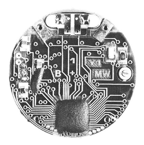
Und das ist die Rückseite derselben Uhr. Man erkennt oben das Gehäuse des Schwingquarzes und ganz unten, in einer schützenden Masse eingegossen, den Microprozessor.
