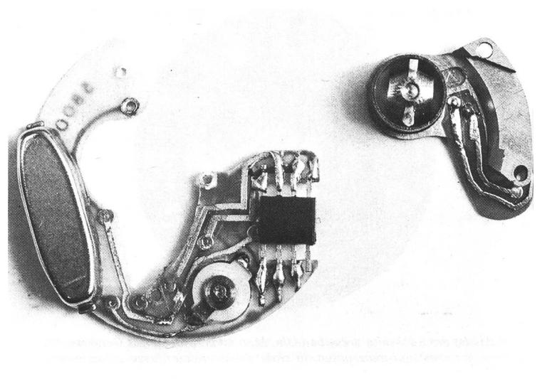
Zwei Bauteile einer elektronischen Uhr: Links in länglichem Gehäuse der Schwingquarz, rechts ein winziger Schrittmotor für Uhren, die die Zeit mit Zifferblatt und Zeigern angeben.
