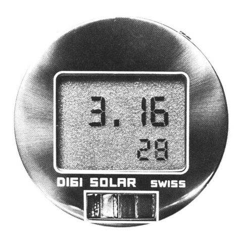
Bei elektronischen Uhren sagt man nicht «Werk», sondern «Modul». Das ist das Modul einer modernen Digital-Armbanduhr, die ihre Antriebsenergie aus Sonnenzellen (im Rechteck unten) bezieht.
