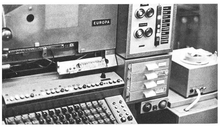
Dieser moderne, lochstreifengesteuerte Setzautomat, der rund 24 000 Buchstaben in der Stunde setzt, wird in wenigen Jahren dem Lichtsatz weichen müssen.
