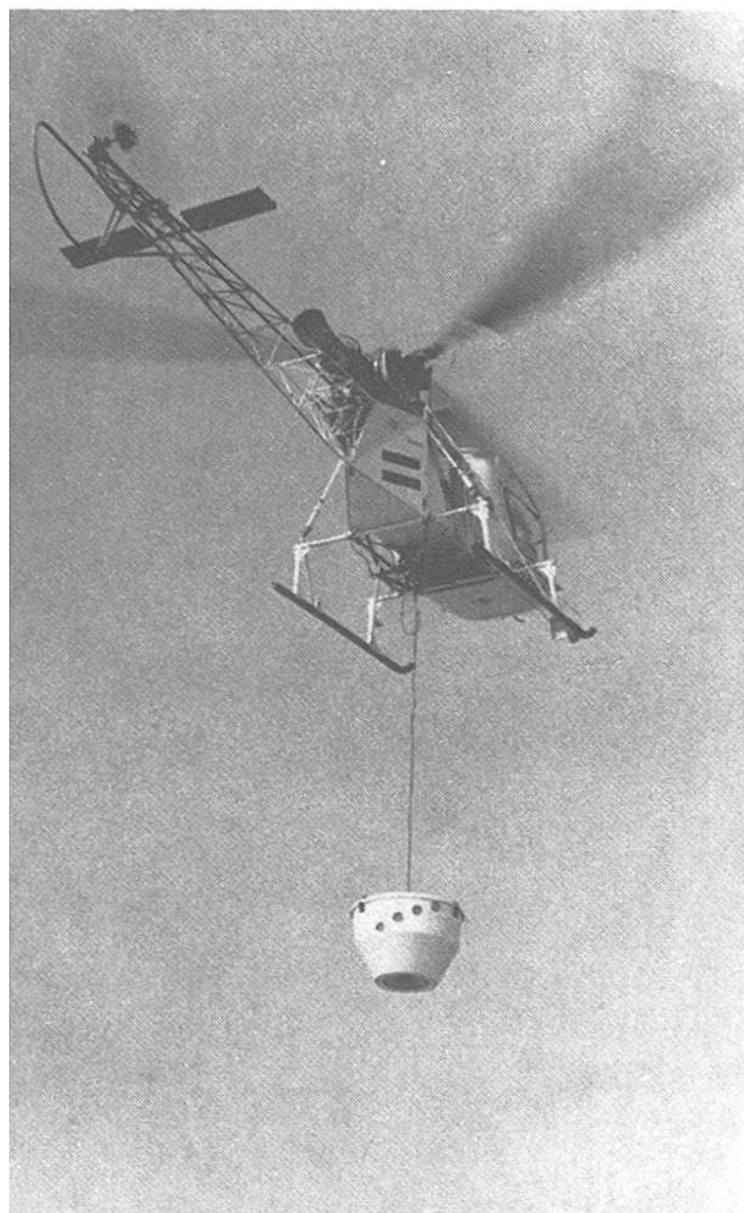
Ein «Helijumper» bringt Wasser und feuerhemmende Chemikalien zur Feuerfront. Sie werden vorwiegend bei Flächen- und Buschfeuer eingesetzt.
