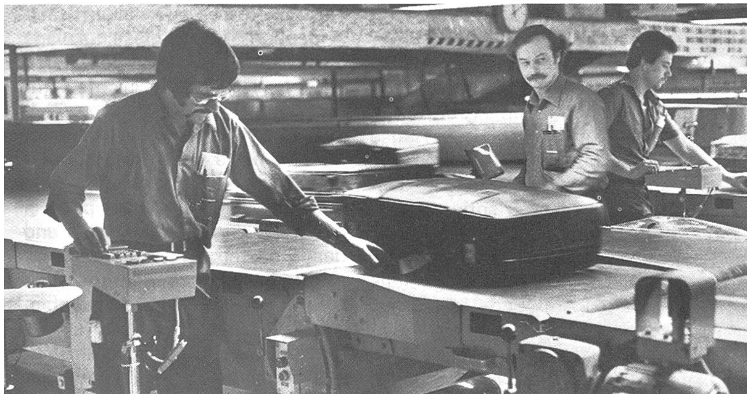
Bei der Kodierstelle werden die Flugnummern jedes Gepäckstückes in den Computer eingegeben.
