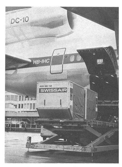
Dank einem leistungsfähigen Verladesystem mit Hebebühnen ist es möglich, diese DC-10 in kurzer Zeit mit den gefüllten Gepäckcontainern zu beladen.
