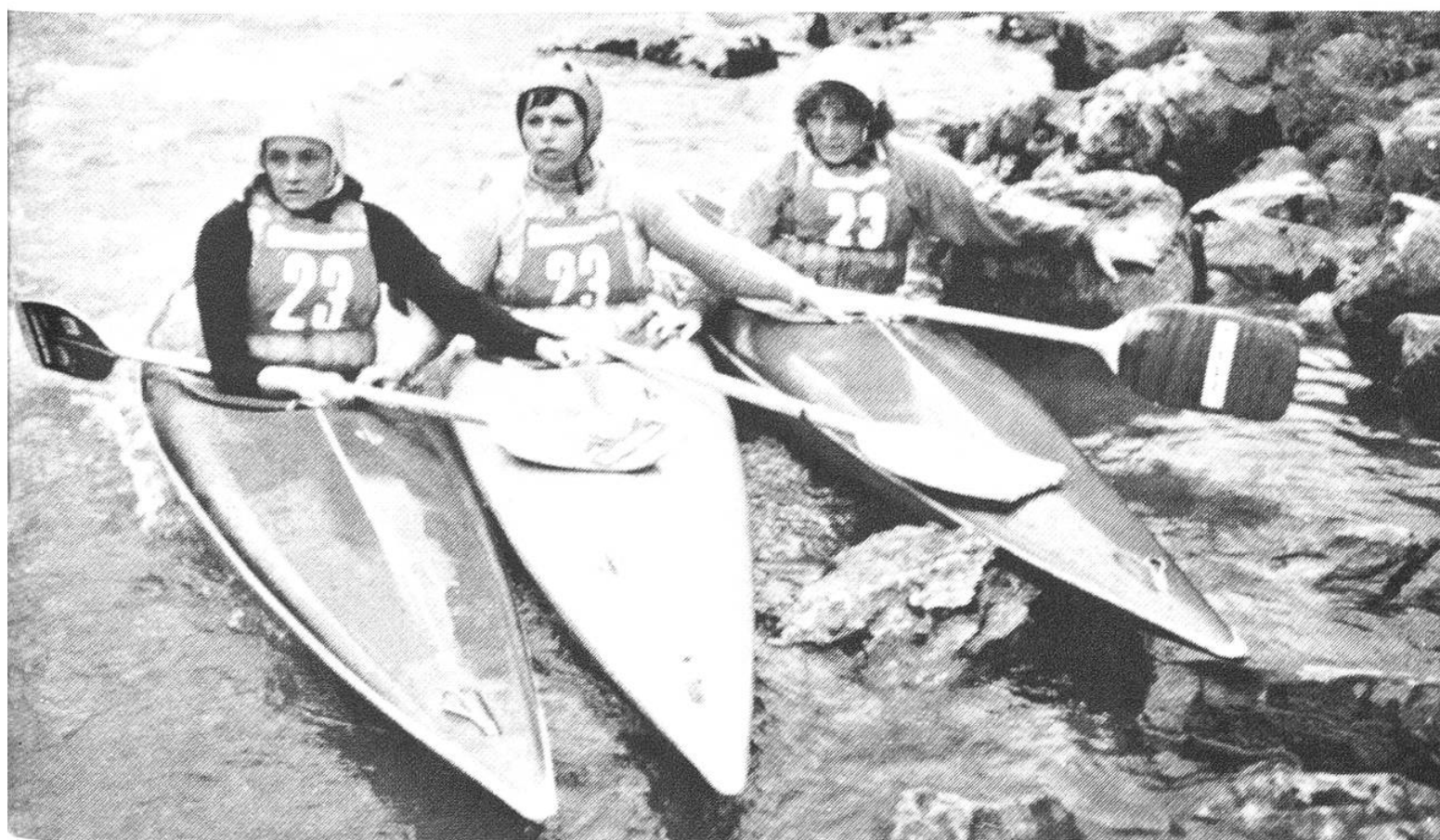
Die Kajaks des an den Weltmeisterschaften 1975 erfolgreichen Schweizer Damenteams wurden aus mit Fasermaterial verstärktem Araldit gefertigt.
