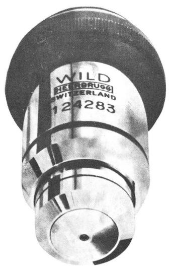
Die Frontlinse dieses Mikroskop-Objektivs, Durchmesser 1,5 Millimeter, kann nicht verschraubt werden. Sie wird mit Araldit auf <sup>1</sup>/<sub>1000</sub> Millimeter genau eingeklebt.
