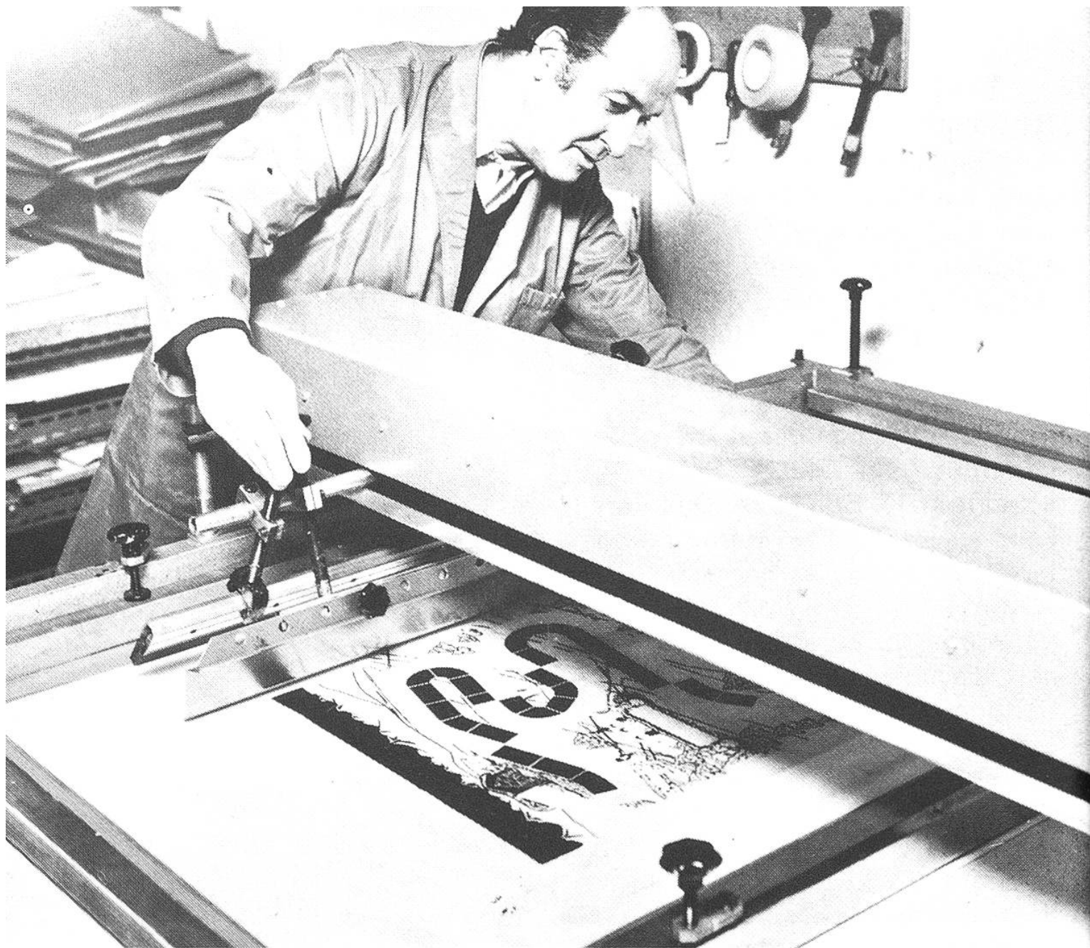
Nun folgt der erste Probedruck. Die Farbe wird durch eine Seidenschablone auf den darunterliegenden Karton gepresst. Eine Arbeit für Spezialisten.
