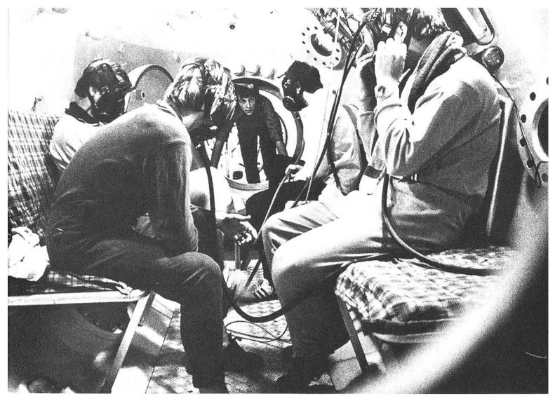
Die Wohnkammer des Zürcher Tauchsimulators. Der Durchstieg im Hintergrund führt in ein kugelförmiges Abteil, unter dem sich eine zweite, wassergefüllte Kugel befindet. In dieser können realistische Unterwasser-Experimente durchgeführt werden.
