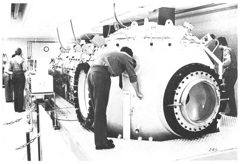
Eine Druckkammer, Tauchsimulator genannt, ist ein ein- oder mehrteiliger Stahltank mit druckfesten Wänden. Wird in ihm ein Überdruck erzeugt, hat dies auf einen darin befindlichen Menschen genau dieselbe Wirkung, als würde er echt im Wasser tauchen. Eine der modernsten Anlagen dieser Art besitzt das Druckkammerlaboratorium am Kantonsspital in Zürich.
