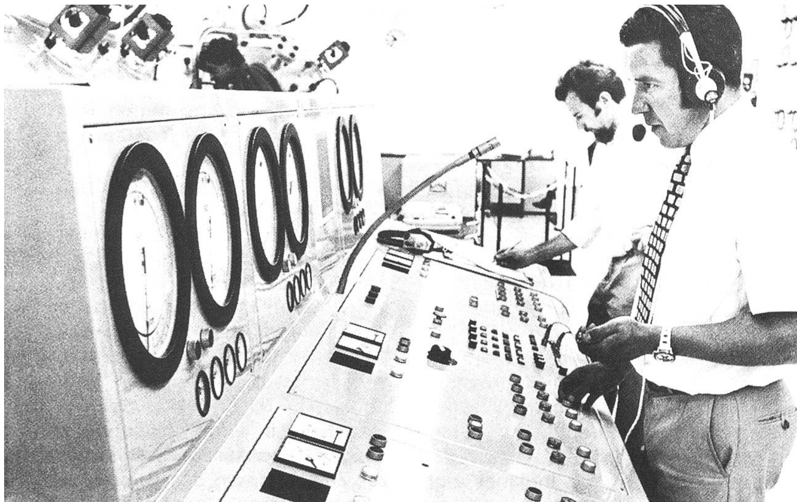
Von diesem zentralen Kommandopult aus steuern und überwachen der technische Leiter des Zürcher Druckkammerlaboratoriums, Benno Schenk, und seine Mitarbeiter sämtliche Vorgänge im Innern des Tauchsimulators.
