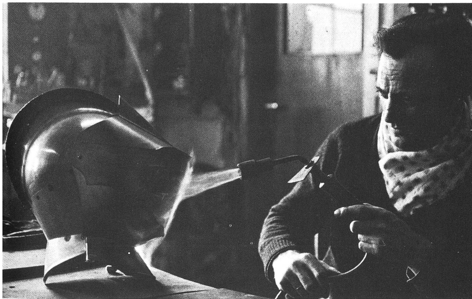
Schweissbrenner und Bohrmaschine sind die einzigen modernen Werkzeuge, die der Würzburger zur Herstellung seiner Rüstungen verwendet.
