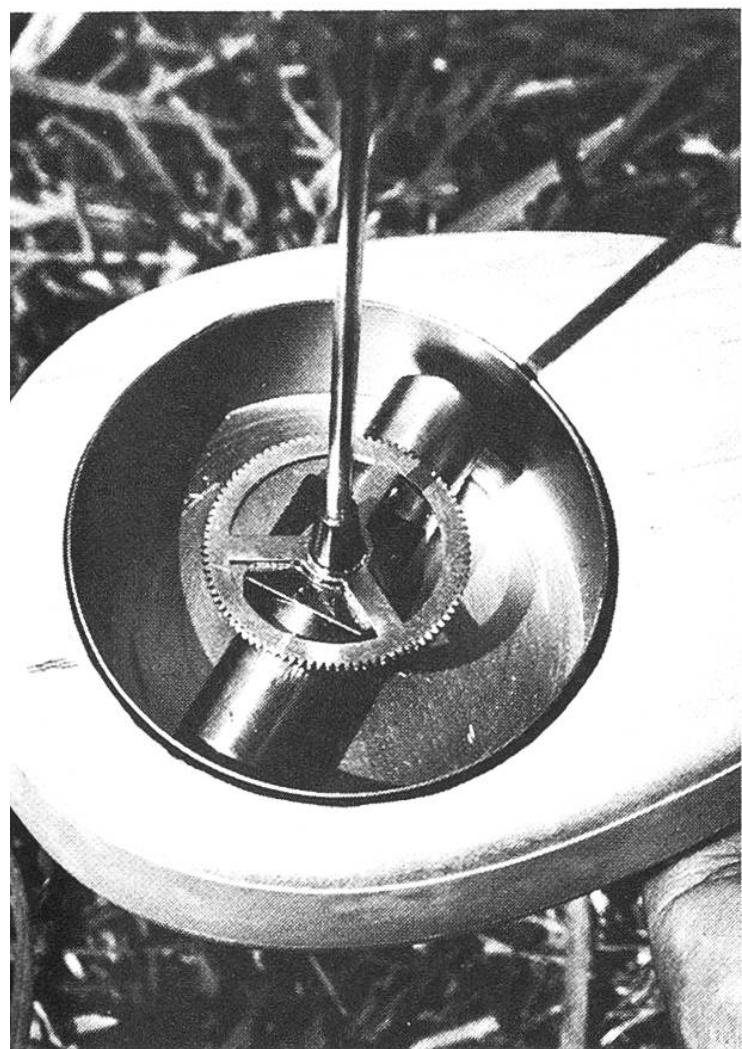
Dies ist das Herz einer Magnetsteuerung: Ein kleiner Stabmagnet, äusserst reibungsarm gelagert und fest verbunden mit einem Zahnrad sowie der Drehachse für die Steuerflosse. Während der Stabmagnet immer ungefähre Nord-Süd-Richtung einnimmt, wird die Steuerflosse entsprechend dem gewünschten Flugkurs auf die Achse aufgesetzt und mit Hilfe eines in das Zahnrad eingreifenden Stiftes fixiert.
