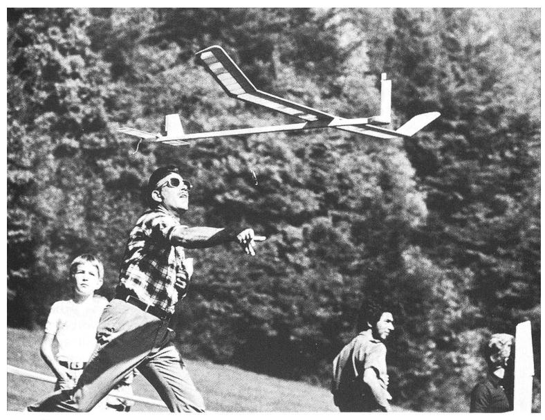
Charakteristisches Kennzeichen eines Segelflugmodells mit magnetischer Kopfsteuerung ist seine verbreiterte Rumpfnase mit darüber senkrecht emporstehender Steuerflosse. Der Bau eines solchen Fliegers erfordert grosse Sorgfalt und Präzision und ist selbst für Erwachsene eine anspruchsvolle Aufgabe.
