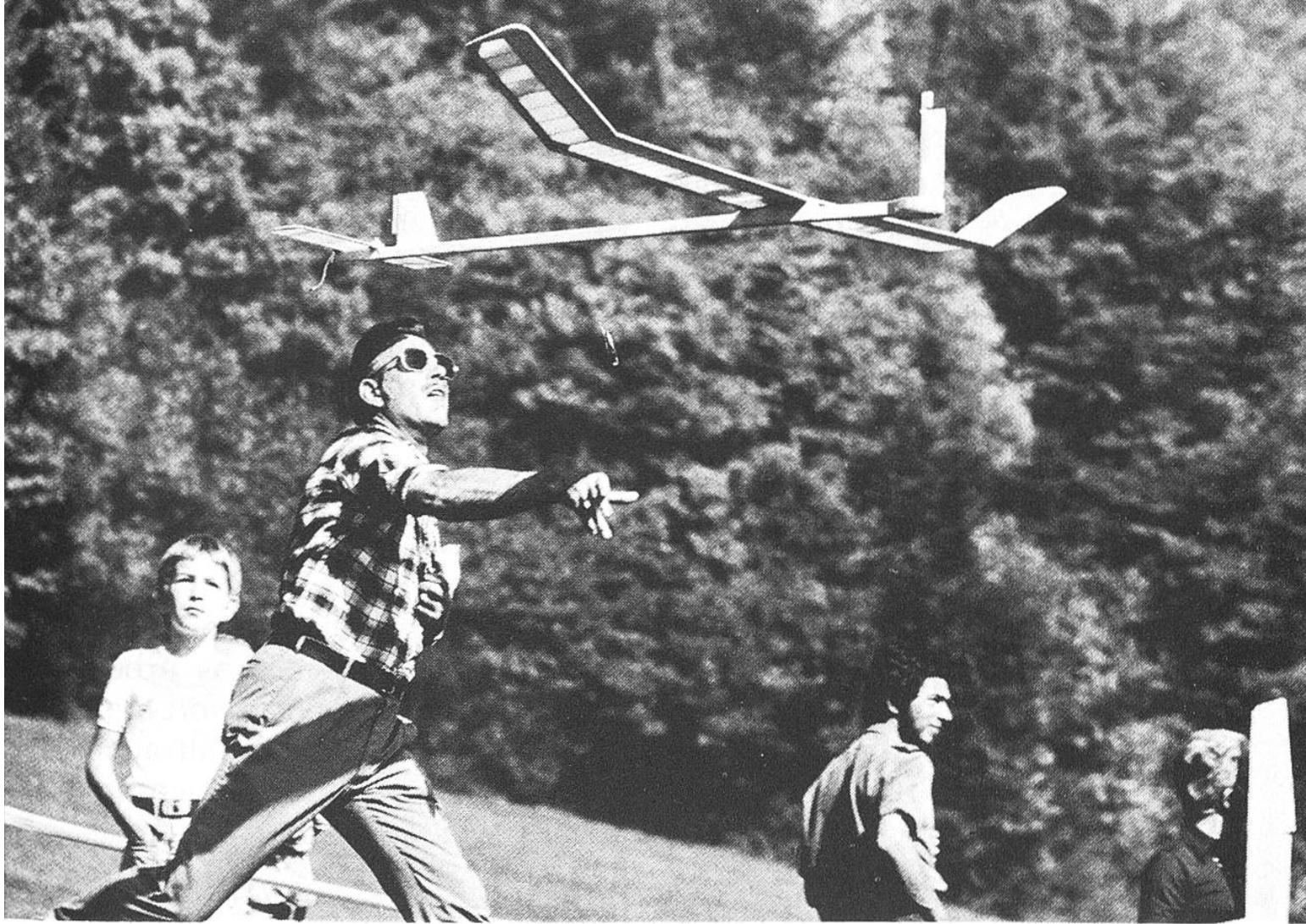
*Charakteristisches Kennzeichen eines Segelflugmodells mit magnetischer Kopfsteuerung ist seine verbreiterte Rumpfnase mit darüber senkrecht emporstehender Steuerflosse. Der Bau eines solchen Fliegers erfordert grosse Sorgfalt und Präzision und ist selbst für Erwachsene eine anspruchsvolle Aufgabe.*
