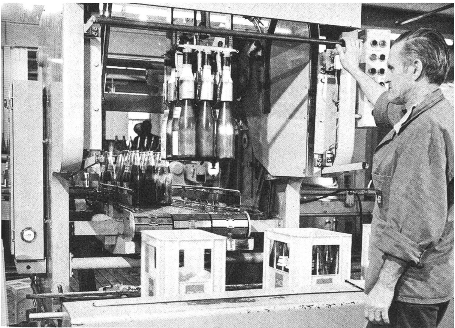
automatisch verschlossen und mit einer hübschen Etikette versehen. Ein nie endender Reigen von mehr als 4000 Flaschen pro Stunde. Zum Schluss **stellte eine raffinierte Maschine die abgefüllten Flaschen direkt in bereitstehende Harasse**, und der Apfelsaft war bereit zur Lieferung.
