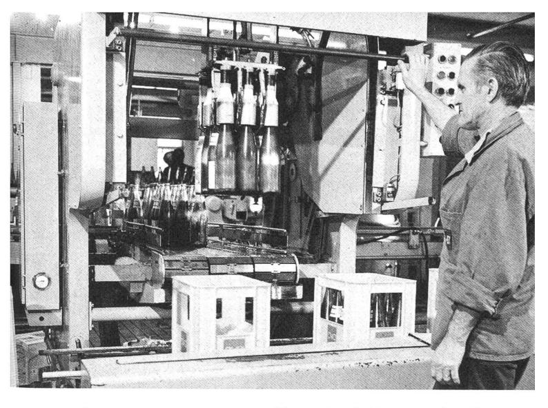
automatisch verschlossen und mit einer hübschen Etikette versehen. Ein nie endender Reigen von mehr als 4000 Flaschen pro Stunde. Zum Schluss stellte eine raffinierte Maschine die abgefüllten Flaschen direkt in bereitstehende Harasse, und der Apfelsaft war bereit zur Lieferung.
