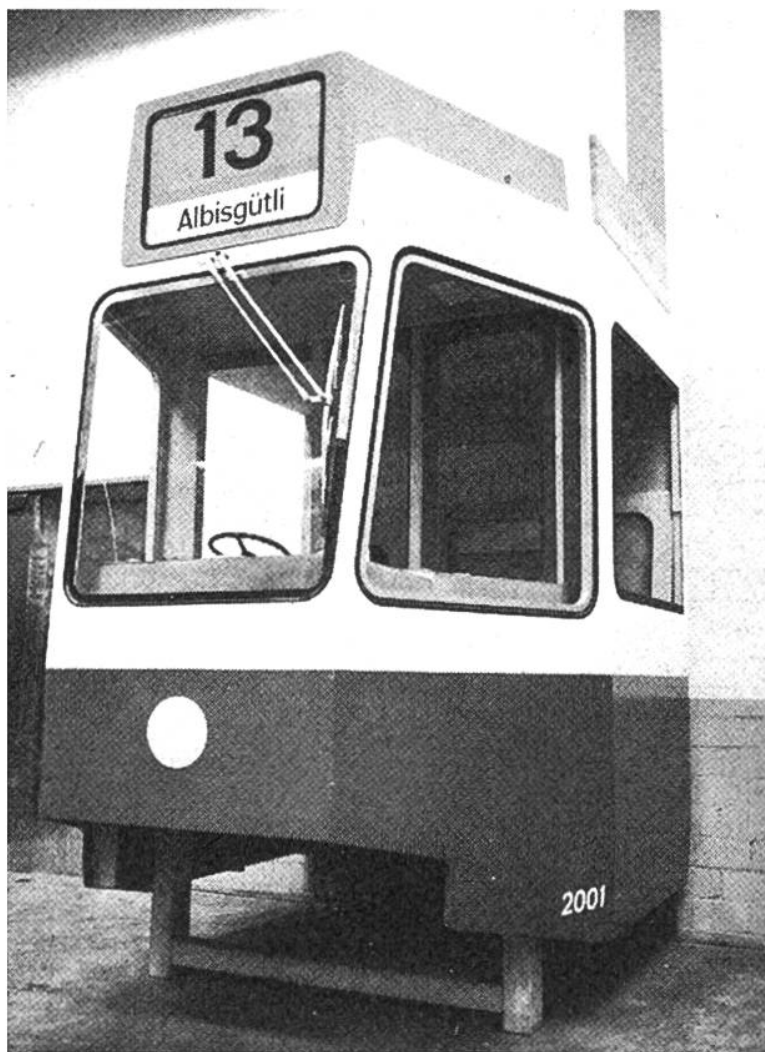
Tram 2000: Maquette der Frontpartie im Massstab 1:1.
