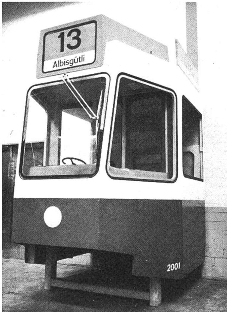
Tram 2000: Maquette der Frontpartie im Massstab 1:1.
