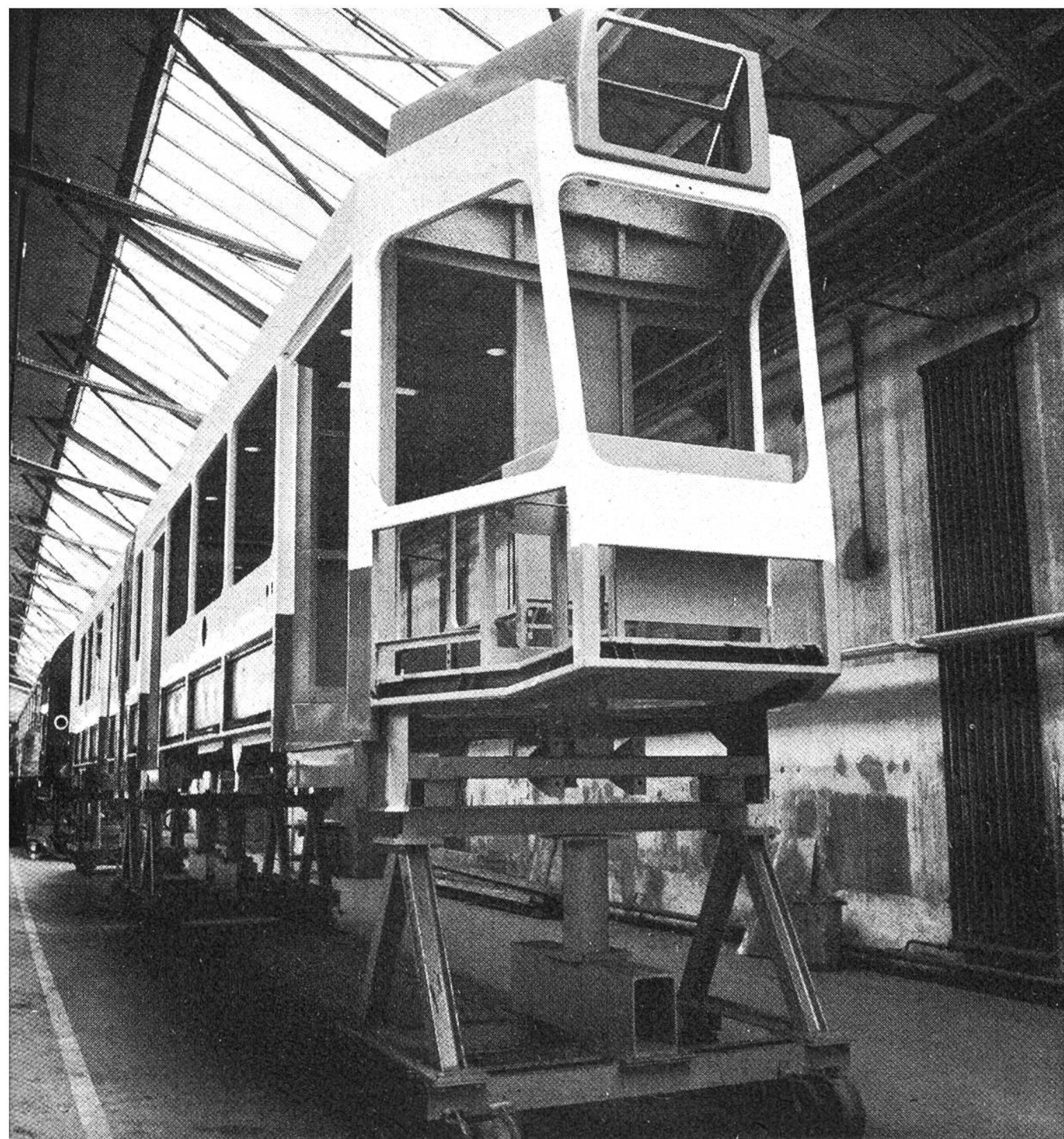
Tram 2000 in Hochmontage (elektrische Installationen, Innenausbau).
