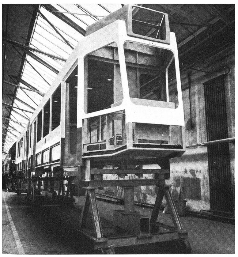
Tram 2000 in Hochmontage (elektrische Installationen, Innenausbau).
