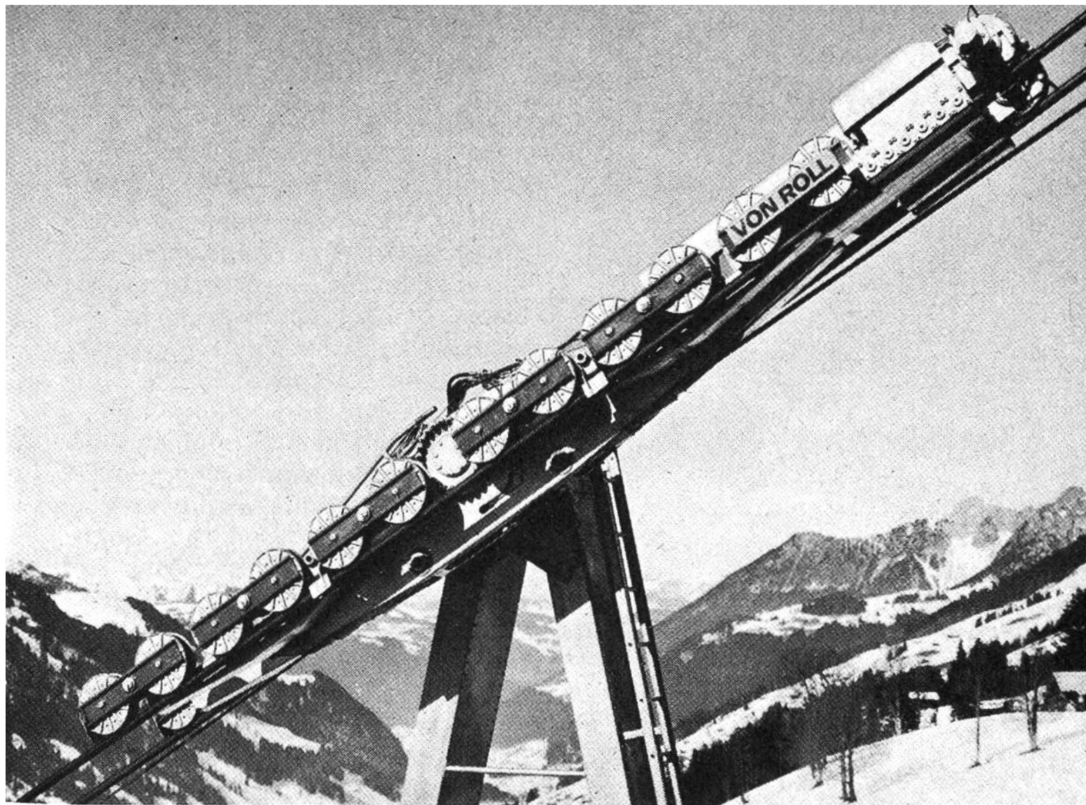
Von-Roll-Laufwerk einer Pendelluftseilbahn, 24rollig, mit angelenktem Bremswagen (Lenk-Metsch).
