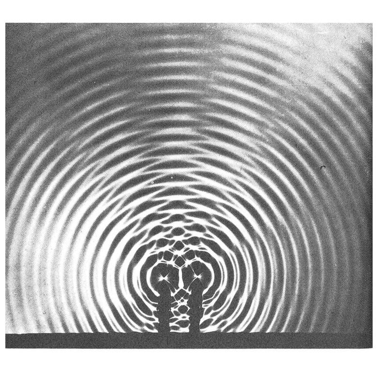
Leuchttürme? Radarstationen? Ein Spinnennetz? Nein, auch diesmal geht die Phantasie zu weit. Zwei kleine feste Körper schwimmen in einer Flüssigkeit, und es wird bewiesen, dass Vibrationen dieser Körper bestimmte regelmässige Wellenbewegungen hervorrufen. Sie schwingen in der gleichen Frequenz. Darum entstehen gleichmässige Überlagerun-
