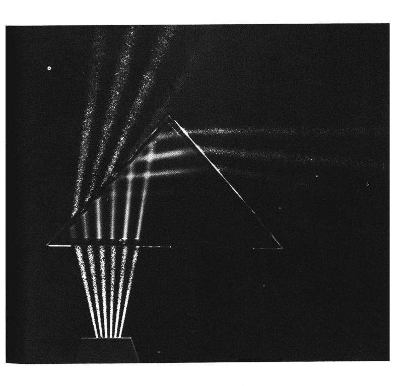
Etwas weniger Raum überlässt diese Aufnahme der Phantasie. Es geht um eine Demonstration des Verhaltens von Lichtstrahlen. Sechs Lichtbündel gehen durch ein mit Wasser gefülltes Gefäss aus Plexiglas. Die Strahlen werden je nach Einfallswinkel gebrochen. Dieses Gesetz wird man um so besser verstehen, je deutlicher es veranschaulicht werden kann. Um die
