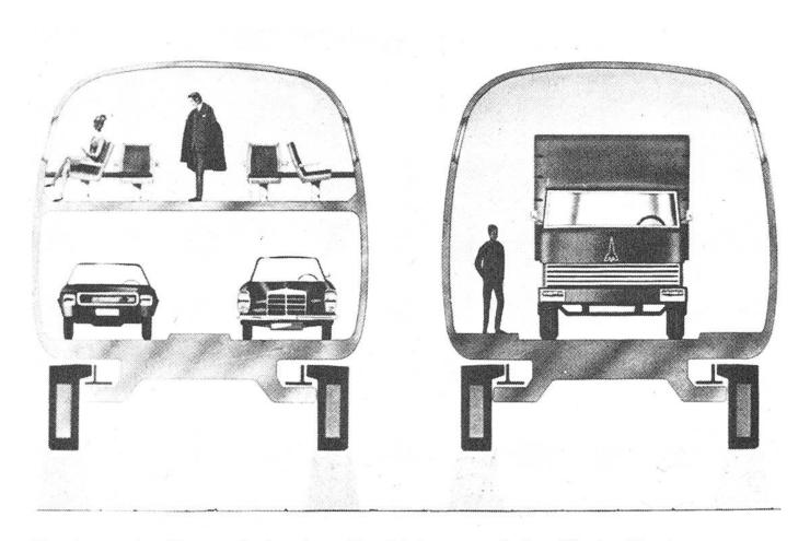
Huckepack – Querschnitt einer Hochleistungs-Schnellbahn für den Transport von Personen, Autos und Lastwagen.
