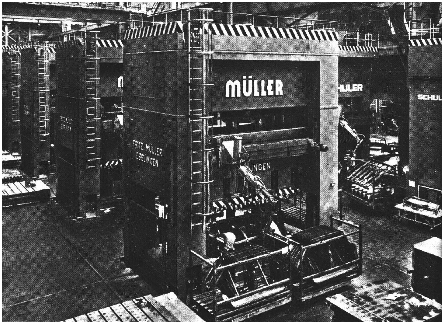
Eine Pressen-«Strasse». Mit 1300 Tonnen Schliesskraft werden die massgerecht zugeschnittenen Blechplatinen verformt.
