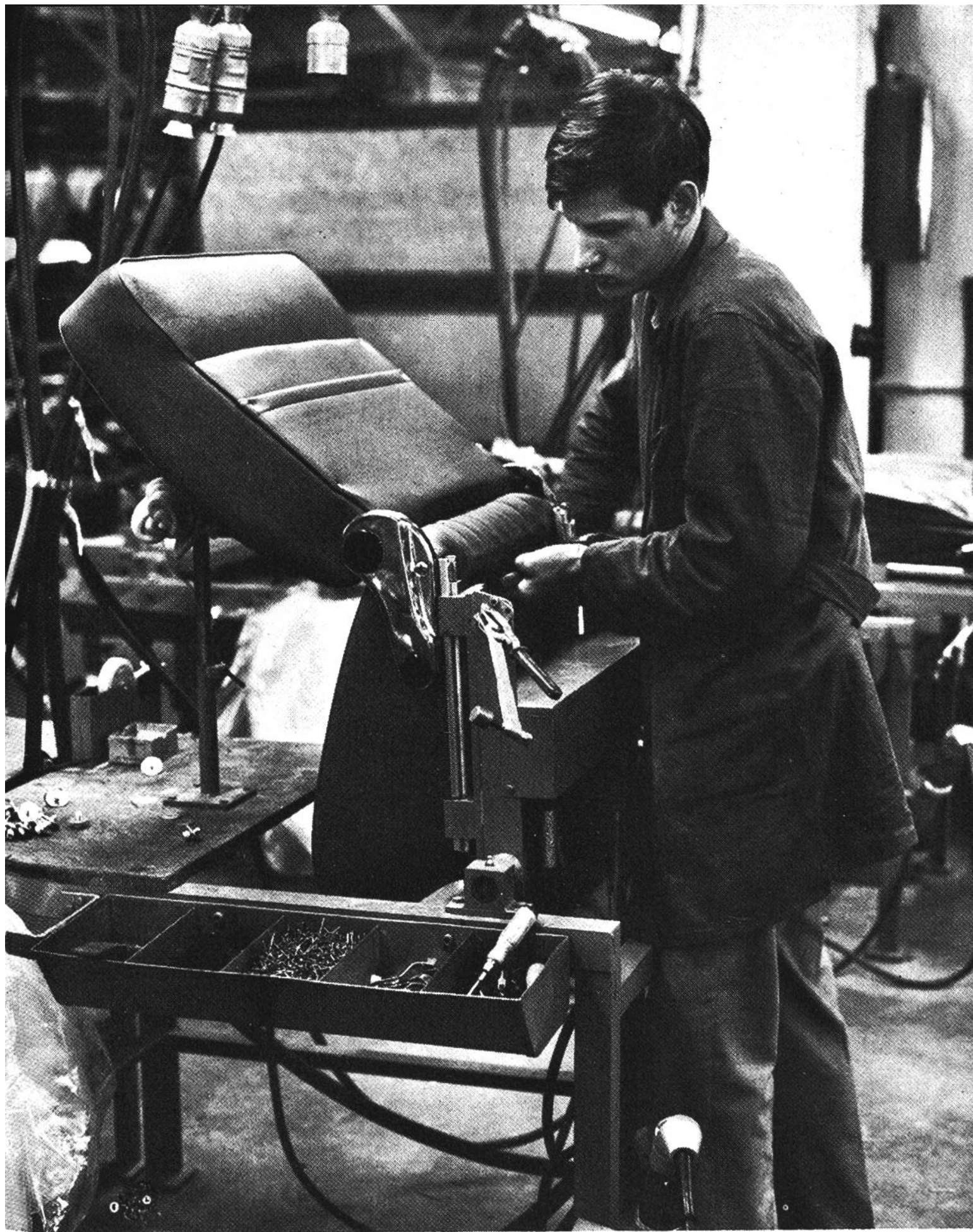
Handarbeit: Zusammenbau der fertig bezogenen Sitzgestelle mit den Verstellmechanismen.
