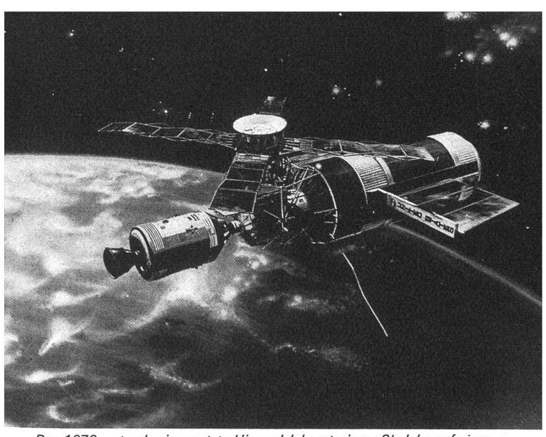
Das 1973 erstmals eingesetzte Himmelslaboratorium «Skylab» auf einer rund 500 km hohen Umlaufbahn um die Erde. Links aussen das Apollo-Raumschiff, anschliessend der Kopplungsverbindungsteil, das Labor und die Wohnräume. Darüber das grosse Teleskop für die Sonnenbeobachtung sowie mit Sonnenzellen versehene Flügel.
