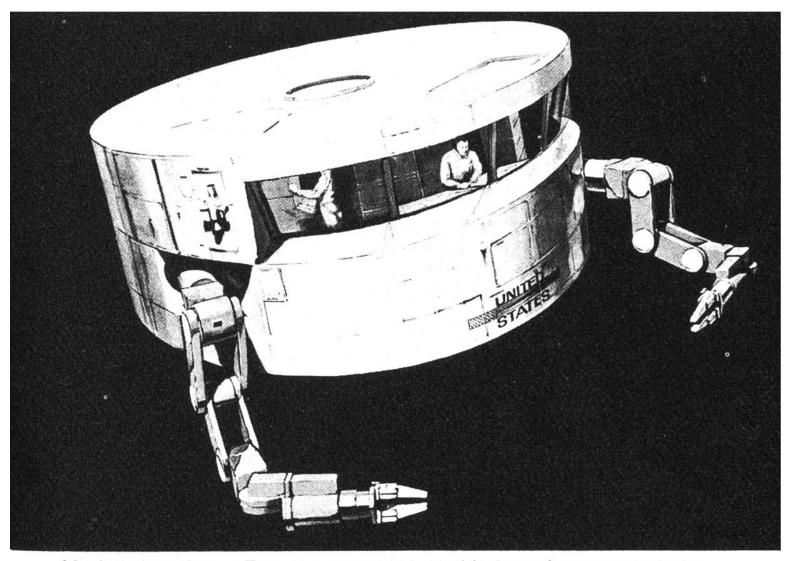
Modell eines Space Tug, der sowohl als Verbindungsfahrzeug zwischen Raumfahrzeugen auf verschiedenen Umlaufbahnen wie aber auch als Reparaturwerkstätte für Satelliten dienen kann.
