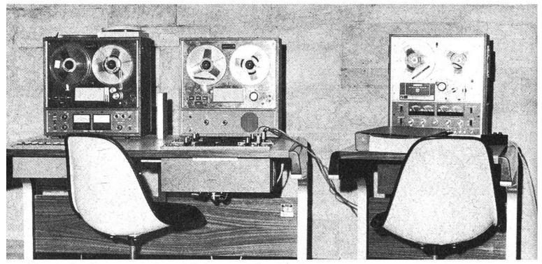
Tonaufnahmegerät kombiniert mit Tonkodierung und Programmprüfer.
