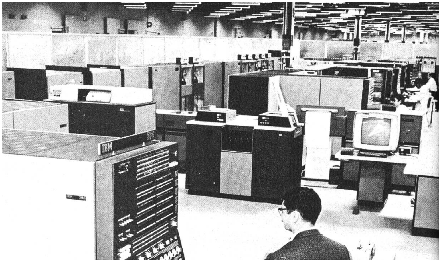
Das Bild zeigt die Montagelinie und eine Testgruppe einer Computerfabrik in Montpellier. Im Vordergrund eine Zentraleinheit, im Hintergrund die Endprüfung dreier solcher Zentraleinheiten.
